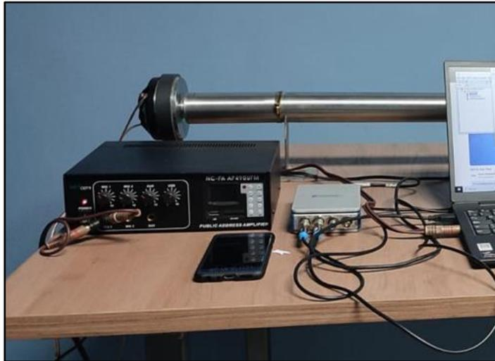
**Ilustración 3-22:** Banco de pruebas-tubo de impedancia
