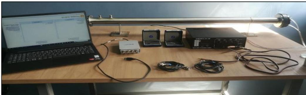
**Ilustración 3-21:** Banco de pruebas tubo de impedancia
