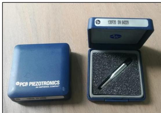
**Ilustración 3-5:** Micrófonos piezoeléctricos
