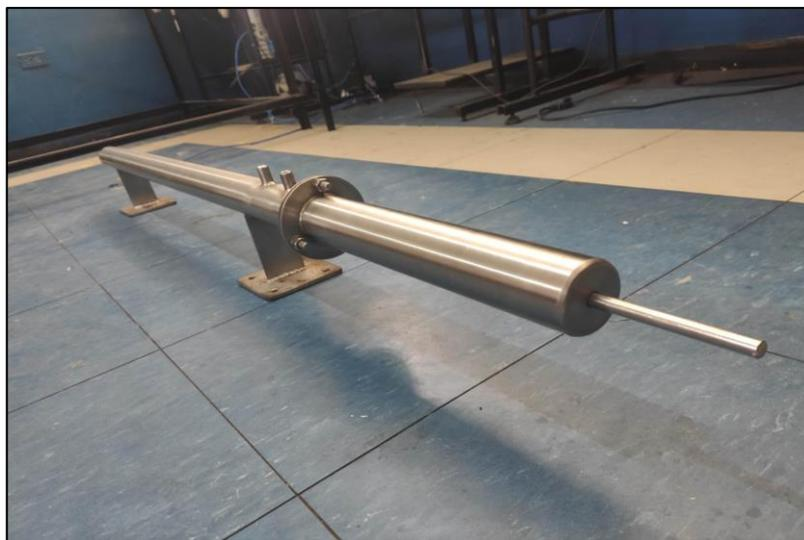
**Ilustración 3-36:** Tubo de impedancia acústica de acero inoxidable
