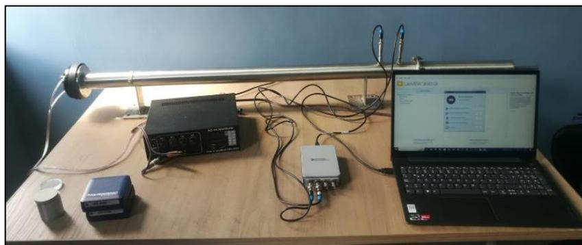
**Ilustración 3-20:** Tubo de impedancia acústica
