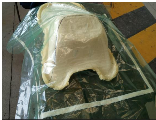
Ilustración 4-7: Plástico de sellado con la forma para aplicar vacío
