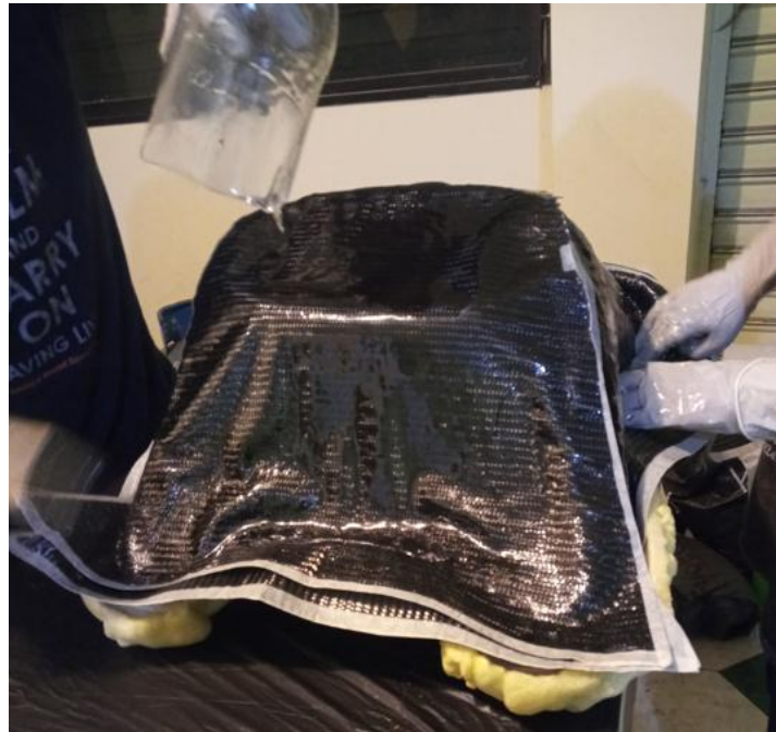
Ilustración 4-9: Laminación en fibra de carbono
