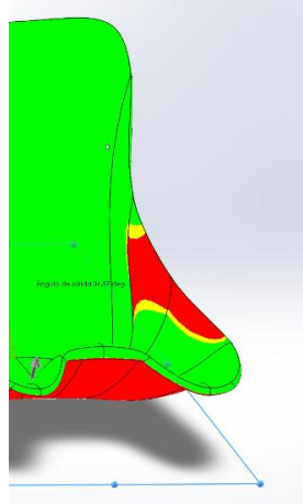
Ilustración 4-3: Angulo negativo de desmoldeo.
