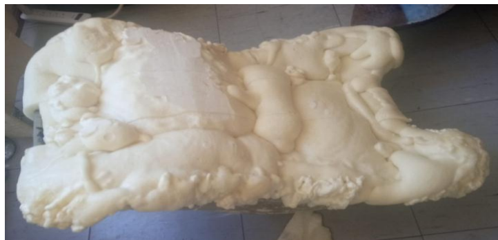
Ilustración 3-29: Espuma de poliuretano expandida en asiento base.
