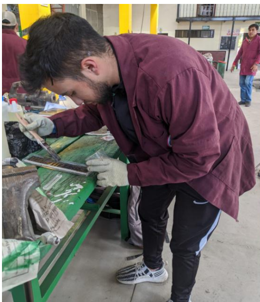
Ilustración 3-8: Creación de las probetas para ensayos destructivos
