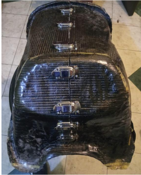
Ilustración 4-15: Corte del Molde y ubicamos las vinchas
