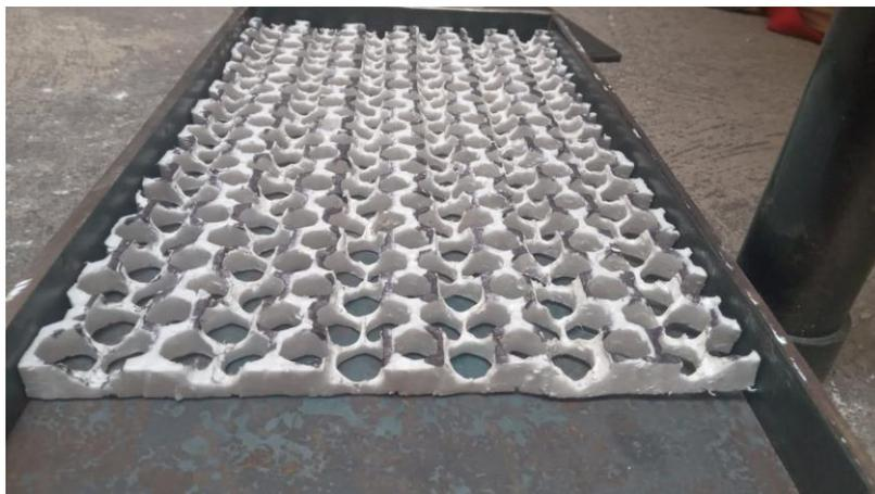
**Figura 11-3.** Verificación del molde y matriz del panel en espumaflex
