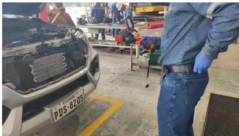
**Figura 1-4.** Medición de temperatura con cámara termografía
