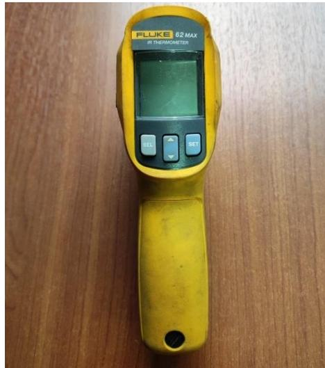
**Figura 17-3.** Pirómetro
