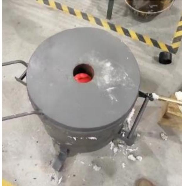
**Figura 2-3.** Horno de fundición de aluminio
