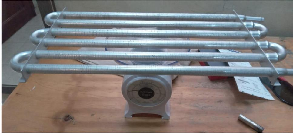
**Figura 5-3.** Peso de los tubos del enfriador
