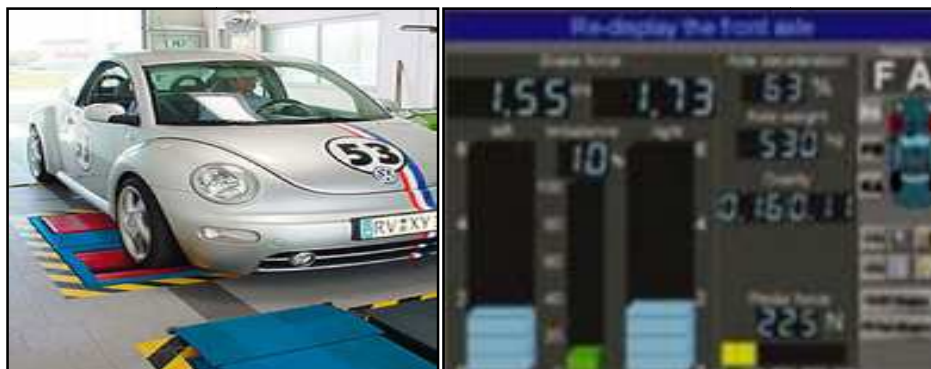
Figura 65. Frenómetro y conexión al servidor.
