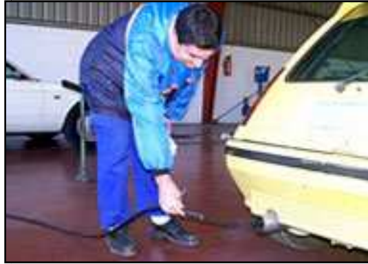
Figura 59. Análisis de gases de escape de automotores a gasolina.
