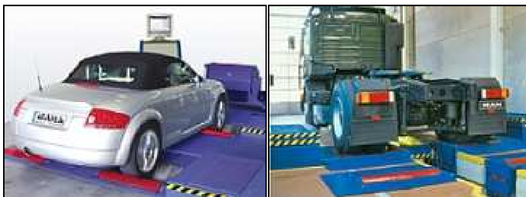
Figura 61. Bancos de potencia dinamométricos para vehículos livianos y pesados.
