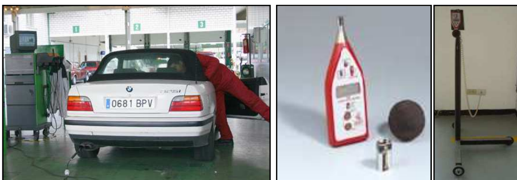
Figura 63. Verificación del ruido vehicular; Sonómetros portátil y de pedestal.
