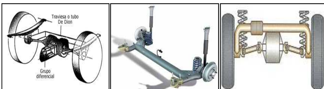
Figura 31. Sistemas eje de Dion; tipo eje Deltalink; y barra Panhard.
