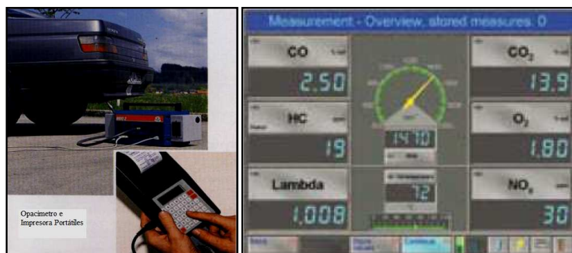
Figura 60. Opacímetro de flujo parcial y conexión al monitor del servidor.
