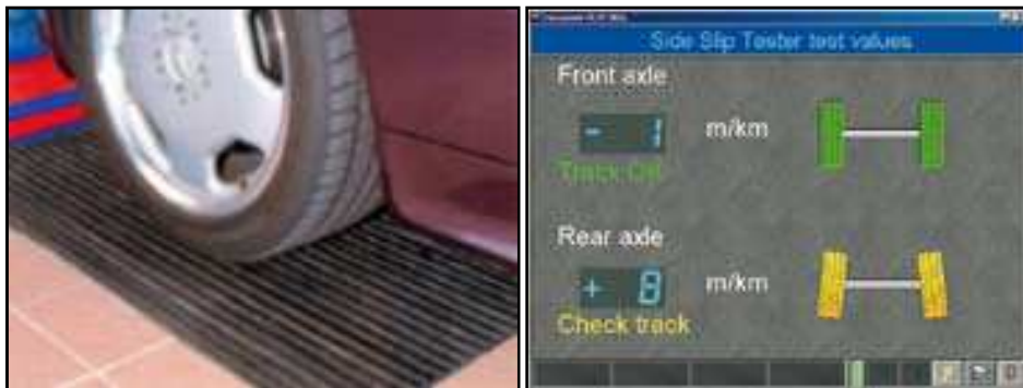
Figura 67. Placa de alineación de ruedas al paso.
