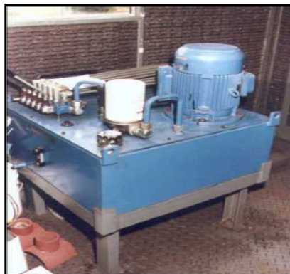
Figura 79. Central hidráulica para el detector de holguras.
