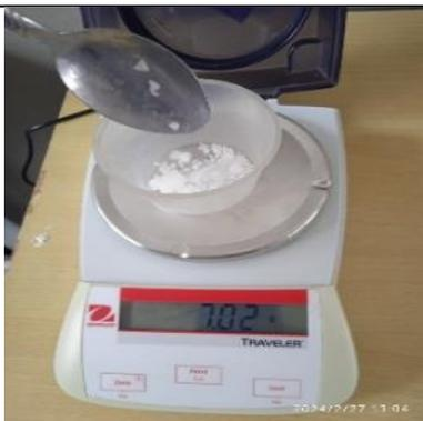
**Figura 9:** Pesaje del Hidróxido de sodio(25g).
