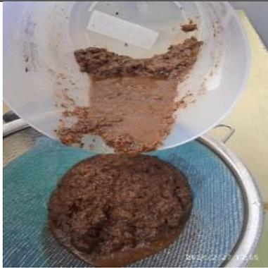
**Figura 11:** Colar la muestra hidrolizada.
