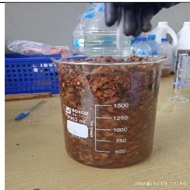
**Figura 8:** Mezcla del acido y agua a la materia prima.
