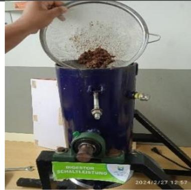
**Figura 12:** Colocar la muestra colada al digestor para la respectiva cocción.
