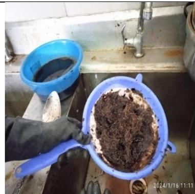
**Figura 14:** Lavado de la muestra cocinada.
