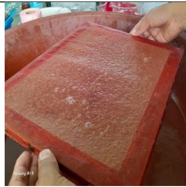
**Figura 17:** Dejar secar la muestra recolectada en el tamiz.
