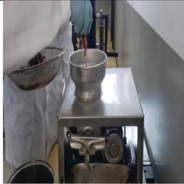
**Figura 15:** Triturar la muestra previamente lavada.
