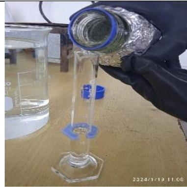
**Figura 6:** Medición del Acido Sulfurico (7ml)
