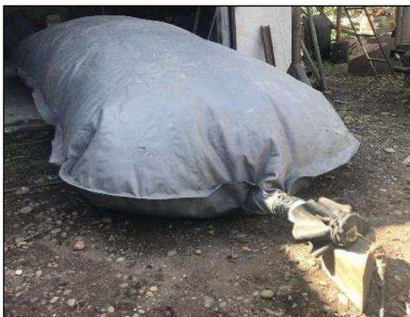
**Ilustración 4-31:** Verificación del hermetismo de la geomembrana
