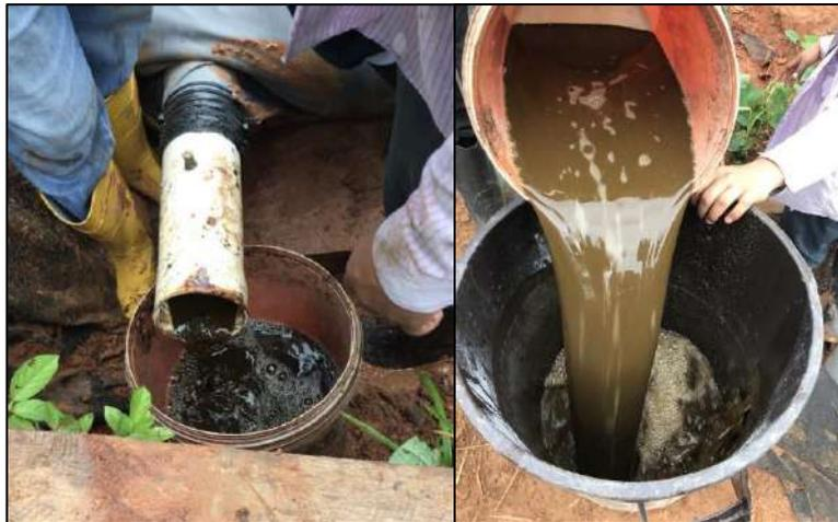
**Ilustración 4-25:** Extracción del biol del biodigestor
