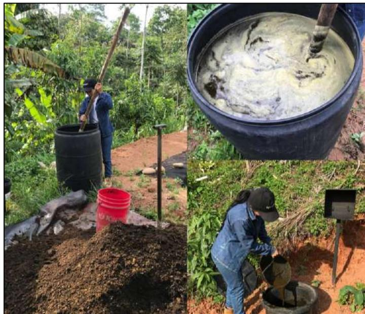
**Ilustración 3-8:** Mezcla estiércol: agua y carga del biodigestor tubular
