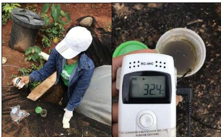
**Ilustración 4-19:** Medición de la temperatura de la mezcla estiércol: agua
