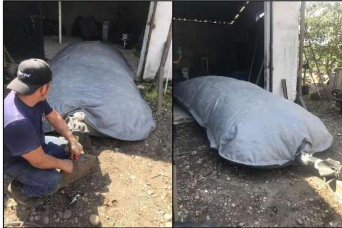
**Ilustración 4-29:** Prueba de hermetismo del biodigestor
