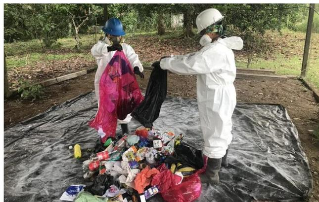
**Ilustración 3-5:** Vertimiento del residuo sobre la superficie plástica
