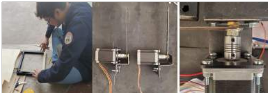
Ilustración 3-64: Construcción del sistema de sujeción
