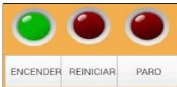
Ilustración 15. Botones de reinicio y apagado de emergencia
