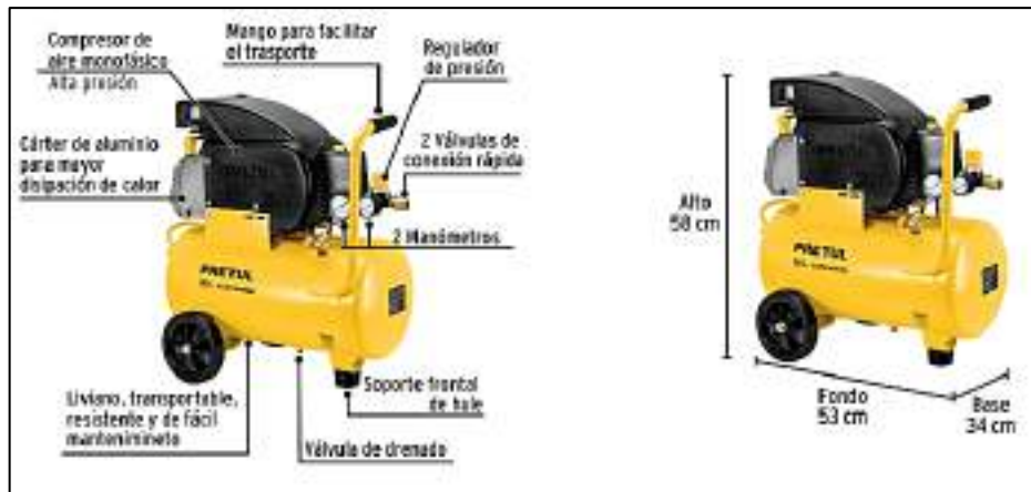
Ilustración 3-38: Componentes y dimensiones del compresor Pretul.
