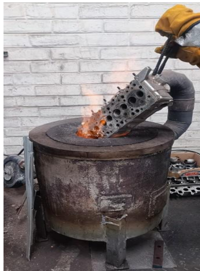
Ilustración 3-41: Ingreso de cabezote al horno.
