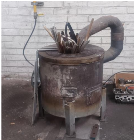
Ilustración 3-43: Ingreso de perfiles al horno.
