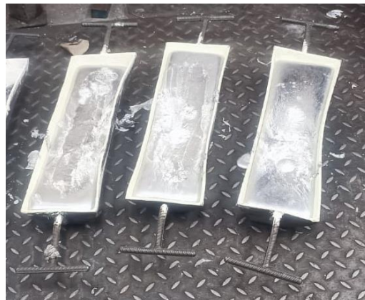
Ilustración 3-45: Lingotes de aluminio en molde.
