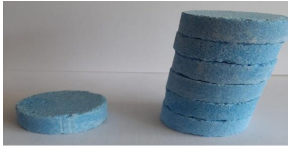
Ilustración 3-6: Pastilla desgasificante para aluminio
