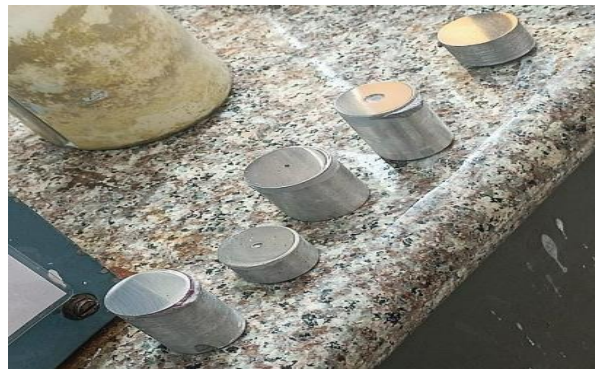
Ilustración 3-31: Probetas después del pulido
