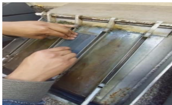
Ilustración 3-29: Desbaste a una probeta para análisis
