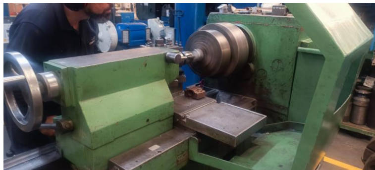
Ilustración 3-50: Torneado de muestra
