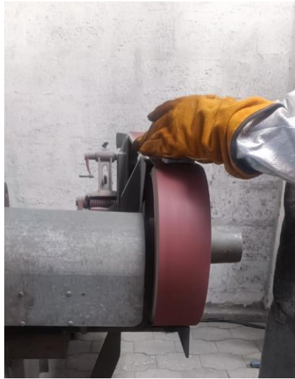
Ilustración 3-49: Lijado de muestra
