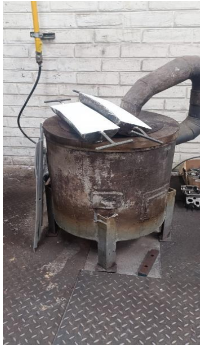
Ilustración 3-42: Calentamiento de moldes.
