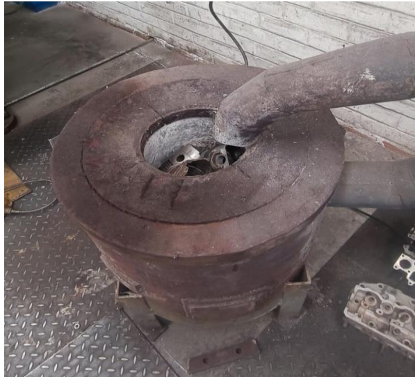
Ilustración 3-40: Ingreso de cabezotes al horno
