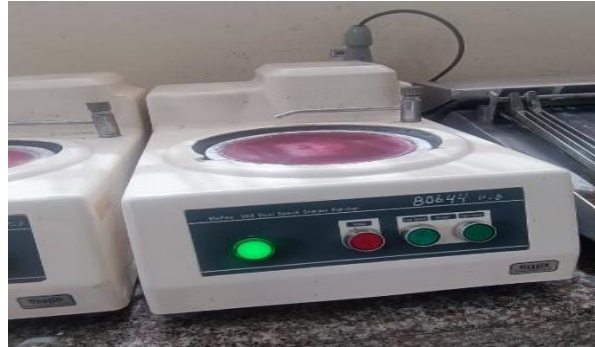
Ilustración 3-30: Amoladora metalográfica de pulido
