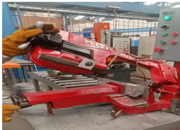
Ilustración 3-47: Corte de lingote en cortadora FAT.
