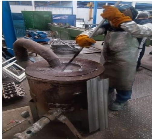
Ilustración 3-44: Mezcla de fundentes en la colada.
