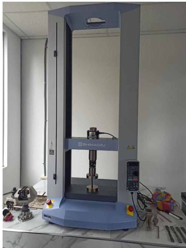
Ilustración 4-2: Máquina electromecánica MTE-50
