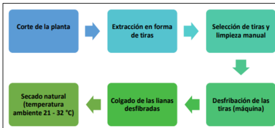
Ilustración 3-2: Proceso de extracción de la fibra de abacá
