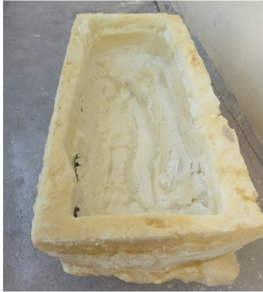
Ilustración 3-20: Molde para la construcción de protector lateral
