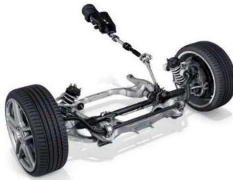
**Ilustración 2-34:** Sistema de dirección
