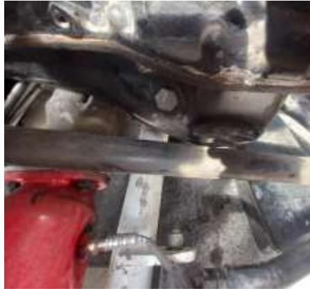
**Ilustración 3-16:** Eje motriz en contacto con el cárter
