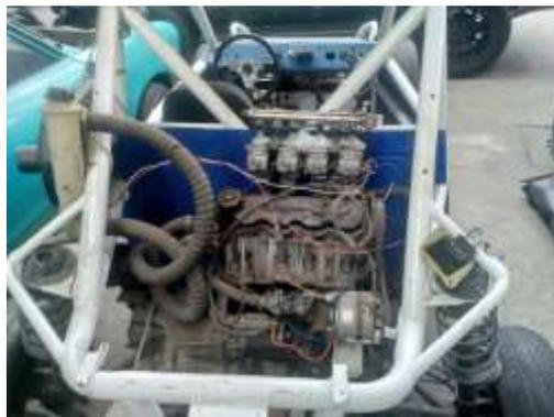
**Ilustración 3-11:** Cableado del arranque y alternador
