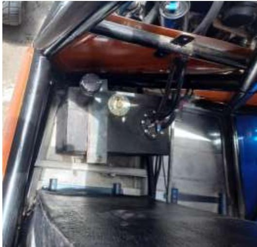
**Ilustración 4-1:** Nueva disposición del tanque de combustible
