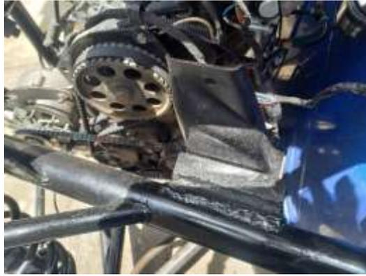
**Ilustración 4-16:** Recorte y suelda de la estructura
