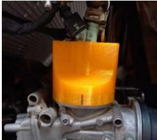
**Ilustración 4-5:** Colocación cornetas sistema de admisión
