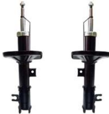
**Ilustración 2-18:** Amortiguadores automotrices
