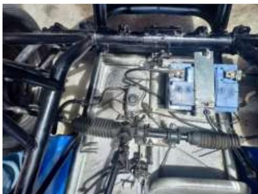
**Ilustración 4-10:** Ubicación y aseguramiento de la batería
