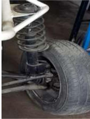
**Ilustración 3-8:** Suspensión en mal estado
