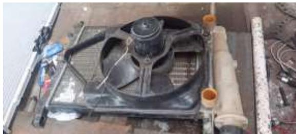
**Ilustración 3-13:** Radiador y ventilador defectuosos
