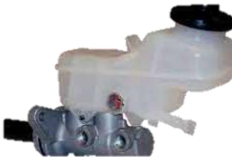
**Ilustración 2-29:** Cilindro maestro de freno
