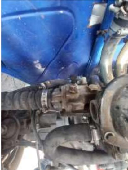
**Ilustración 3-14:** Perno en lugar de sensor de temperatura
