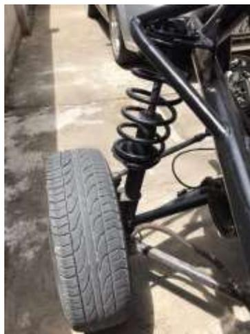
**Ilustración 4-7:** Sistema de suspensión optimizado
