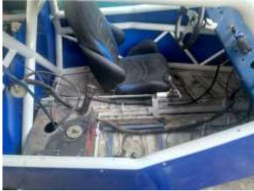
**Ilustración 3-6:** Disposición del tanque de combustible
