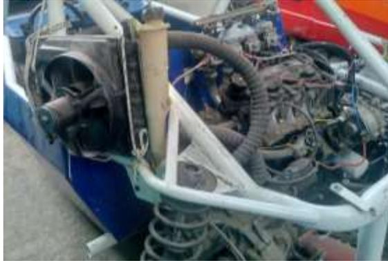
**Ilustración 3-12:** Radiador y ventilador mal ubicados
