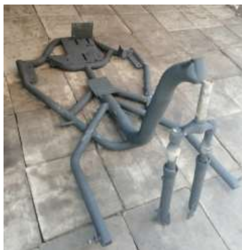
Ilustración 3-10: Proceso de fondeado
