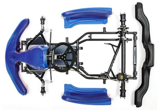
**Ilustración 2-3:** Carrocería o carenado de un kart
