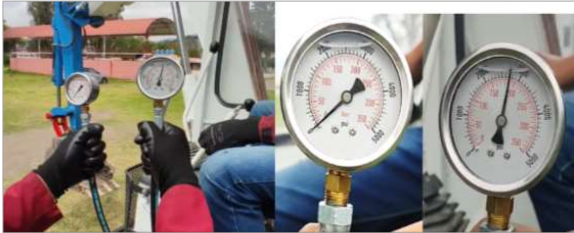
Ilustración 4-2: Manómetro marcando 2710 PSI aproximadamente. Realizado por: Peñafiel V. & Toaquiza G., 2023.
