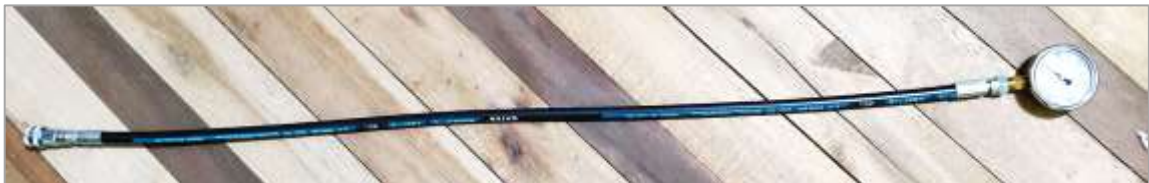
Ilustración 3-25: Ensamble de manguera 4 MXT de 1/4" y manómetro de presión de 5000 PSI. Realizado por: Peñafiel V. & Toaquiza G., 2024.
