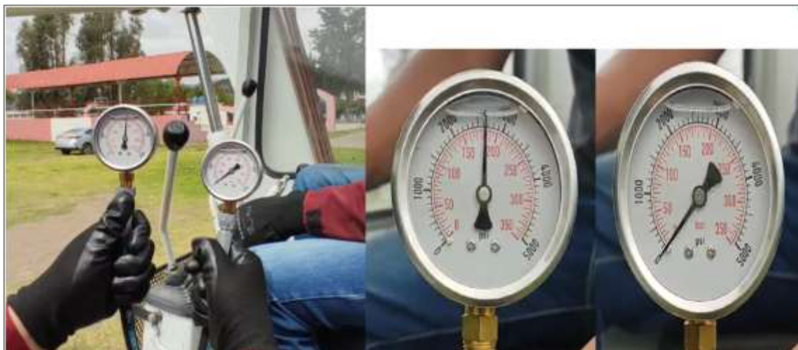
Ilustración 4-3: Manómetro marcando 2630 PSI. Realizado por: Peñafiel V. & Toaquiza G., 2023.
