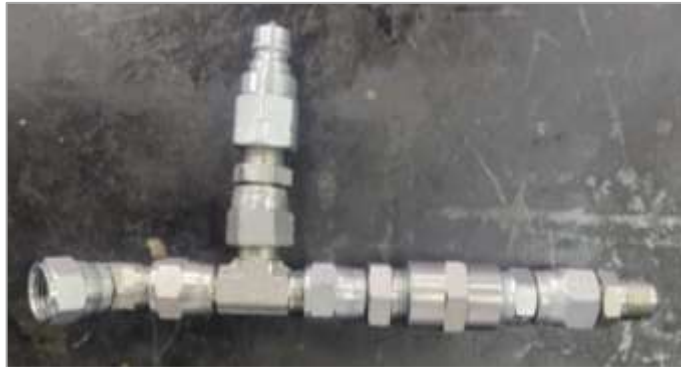
Ilustración 3-24: Ensamble de acoples JIC, NPT 3/8". Realizado por: Peñafiel V. & Toaquiza G., 2024.
