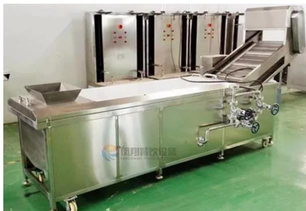
**Ilustración 5-22:** Máquina de escaldado
