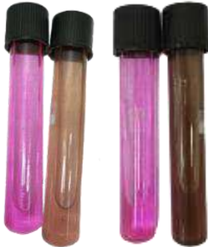
Gráfico 3-9: Cambio de coloración de la solución con tiocianato y Rodamina B
