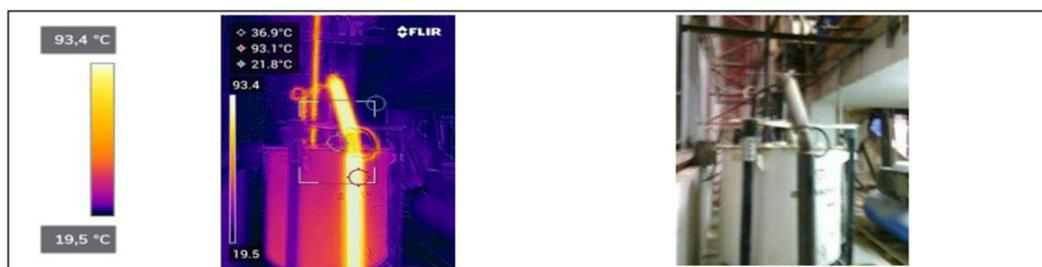
**Ilustración 4-9:** Termografía de tanque interno-balanza
