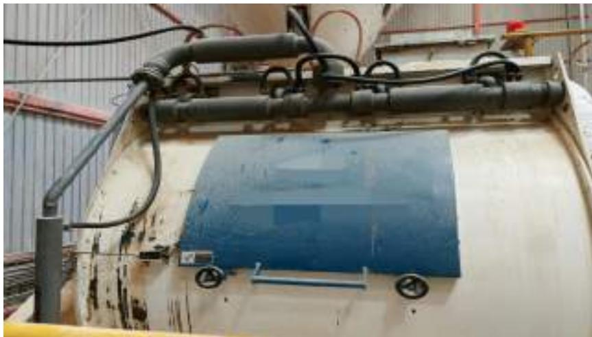
**Ilustración 2-15:** Intercambiador de calor de doble tubo concéntrico encaquetado hacia mezcladora batch
