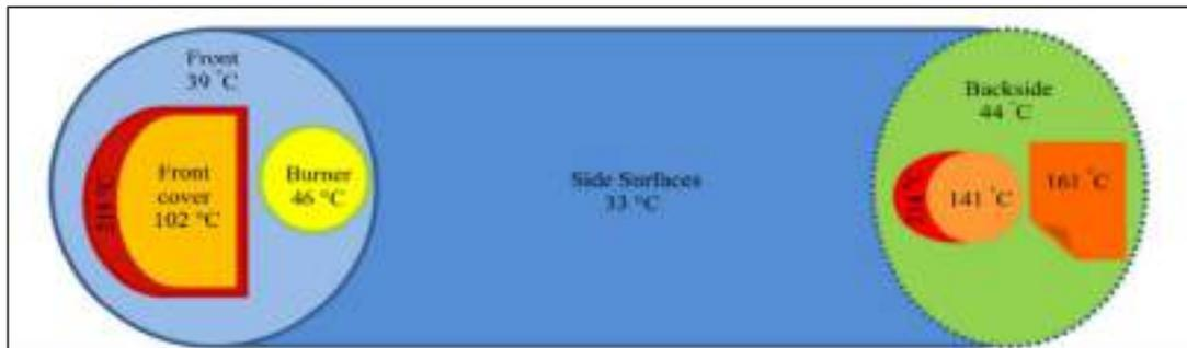
**Ilustración 2-25:** Temperaturas exterior de carcasa par caldera pirotubular
