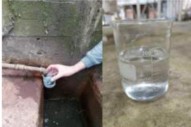
**Ilustración 4-14:** Medición de caudal de condensado en equilibrio térmico
