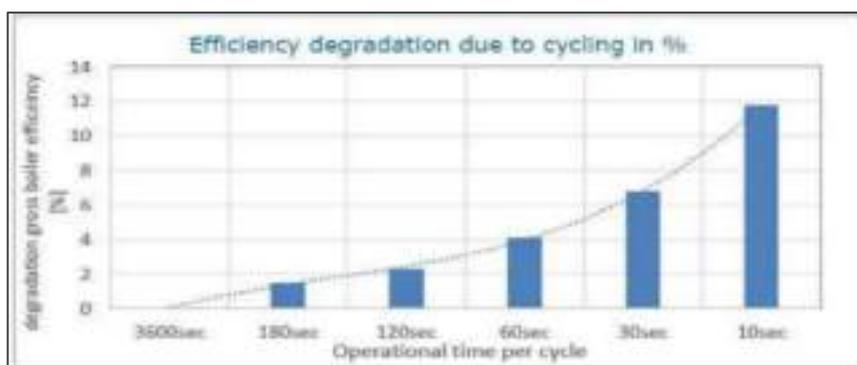
**Ilustración 2-24:** Degradación de la eficiencia estacionaria versus tiempo en funcionamiento por ciclo
