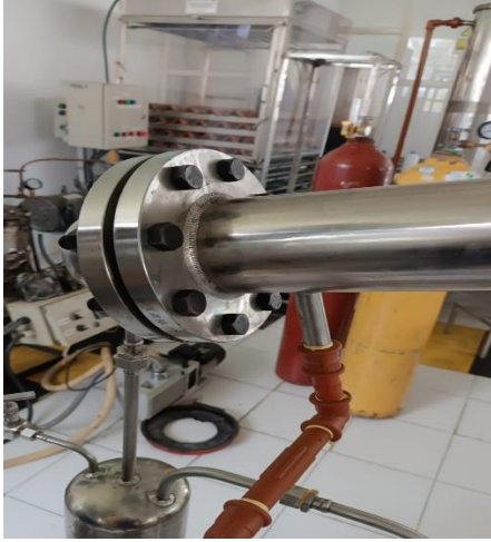
Fotografía N°1. Comprobación de fugas en el equipo.
