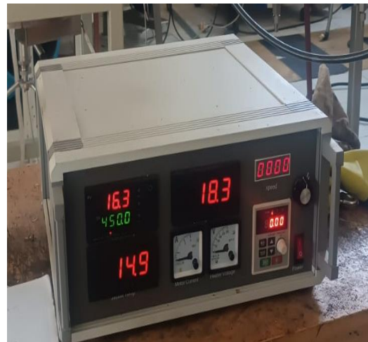
Fotografía N°4. Prueba del funcionamiento correcto del controlador de temperatura.
