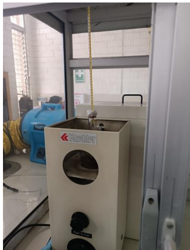
Ilustración 3-7. Equipo de destilación.
