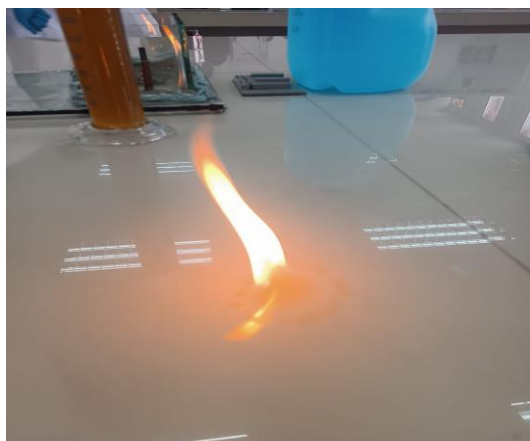
Ilustración 3-5. Determinación de Flash Point a temperatura ambiente.
