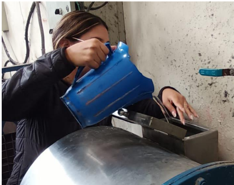
Ilustración 3-5: Adición de los colorantes en el proceso de tintura
