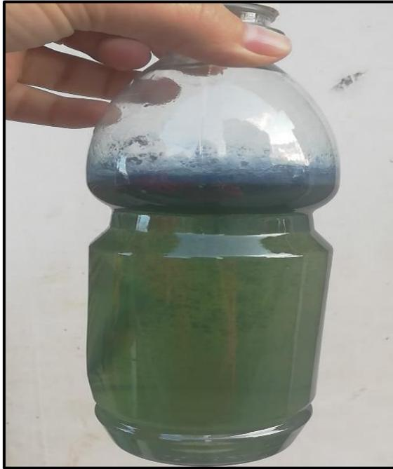
**Ilustración 3-24:** Muestra de agua cruda con hipoclorito de sodio, sulfato ferroso y poliacrilamida
