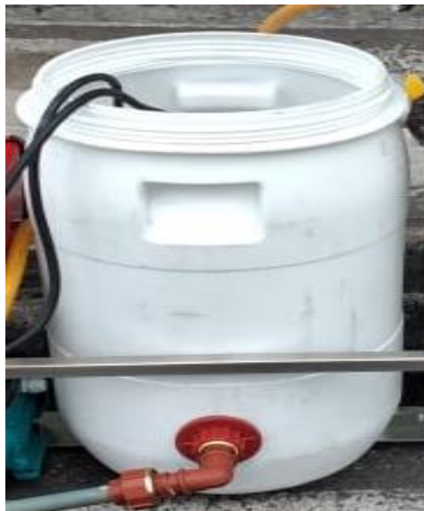
Ilustración 3-7: Barril de almacenamiento de agua residual
