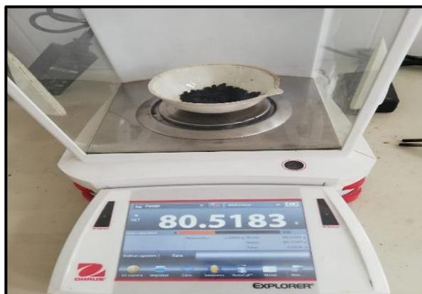
**Ilustración 3-23:** Pesaje de la cápsula con el carbón
