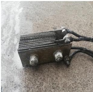
Celda para la electrocoagulación
