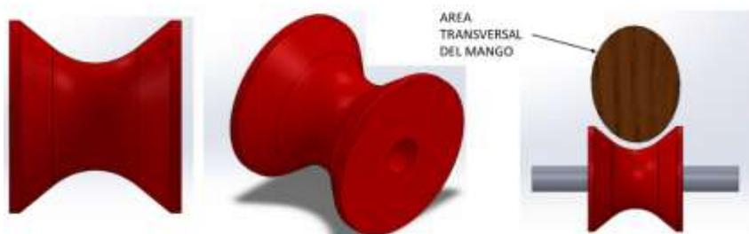
**Ilustración 3-23:** Pieza para levantar el martillo
