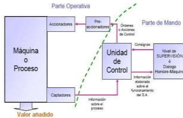
**Ilustración 2-5:** Estructura de un sistema automatizado
