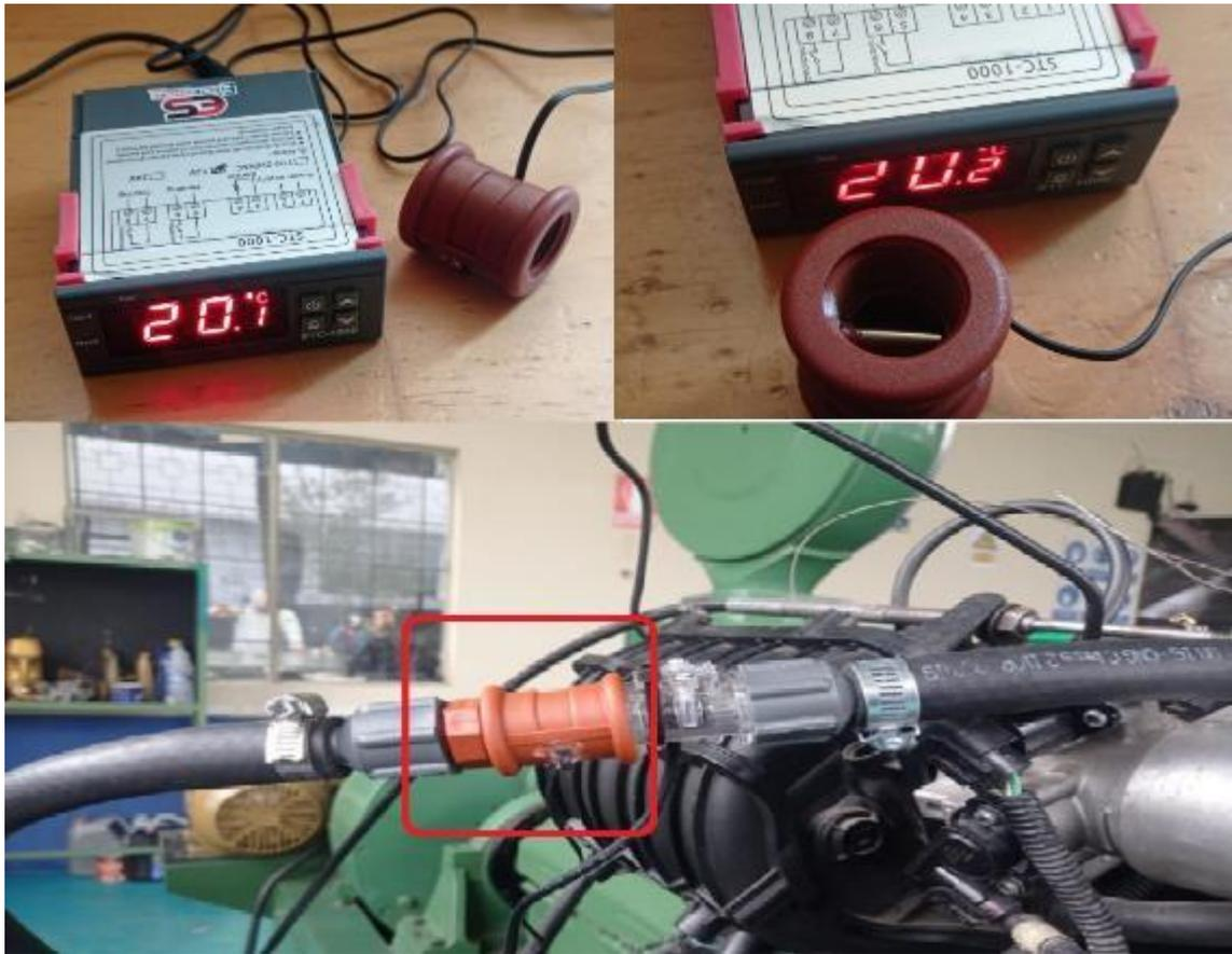
**Ilustración 3-15:** Equipo de medición de temperatura de combustible.
