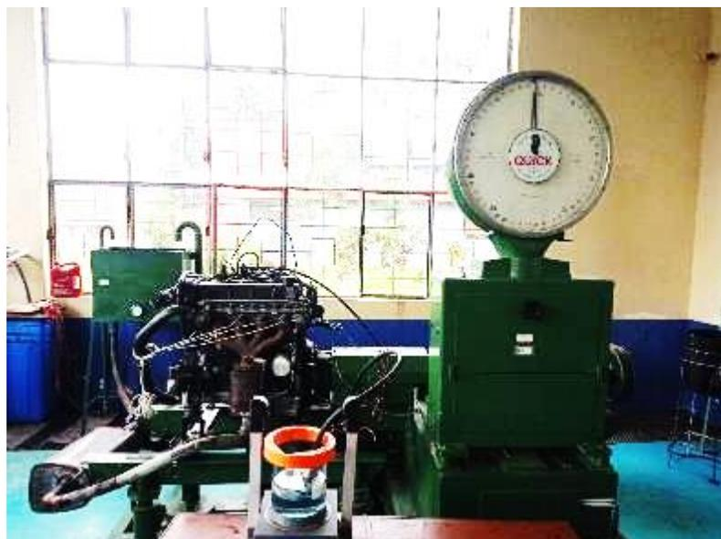
**Ilustración 3-5:** Dinamómetro DYNO\_BORGHIS&SAVERI.
