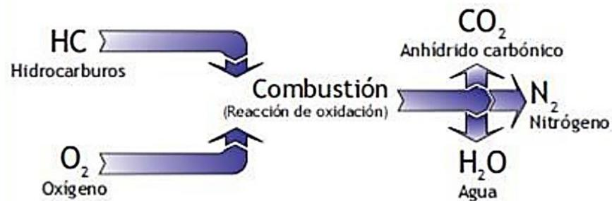
**Ilustración 2-3:** Esquema de la combustión perfecta.
