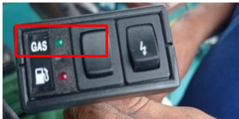
**Ilustración 3-23:** Suich de encendido de conmutador modo GLP.
