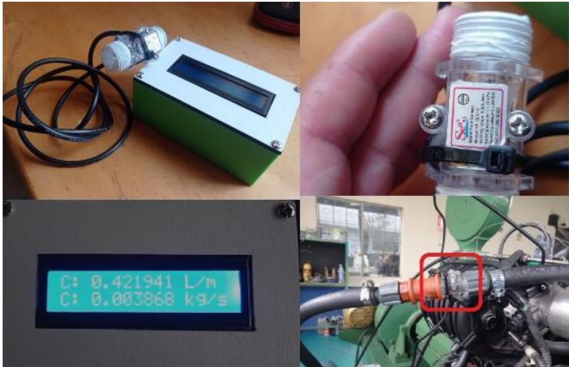
**Ilustración 3-14:** Equipo de medición de consumo de combustible caudalímetro digital.
