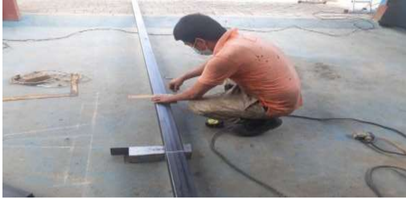
ANEXO D: ARMADA Y PUESTA A ESCUADRA TUBO CUADRADO DE LA PRIMERA SECCIÓN DE LA SURCADORA
