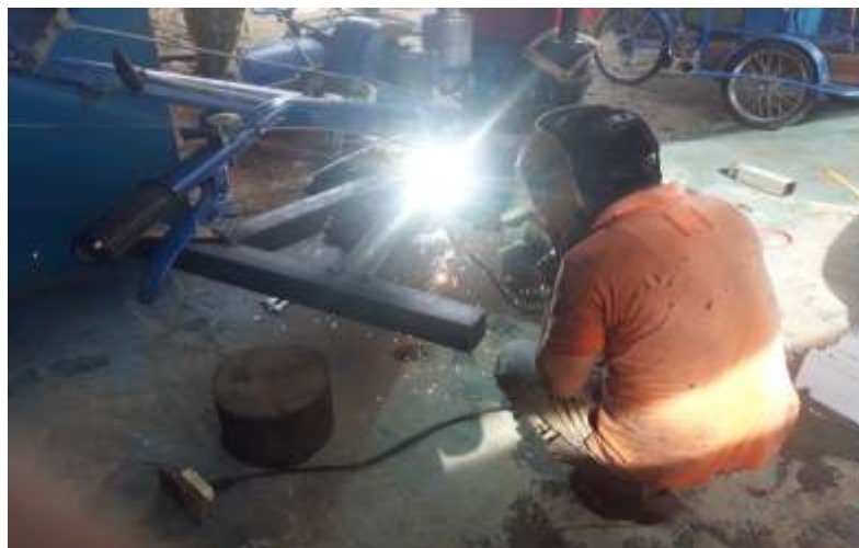
ANEXO E: COLOCACIÓN Y PUNTEADA DE LA SURCADORA DE LA PRIMERA SECCIÓN DE LA SURCADORA AL MOTOCULTOR
