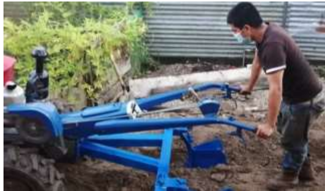
Ilustración 3. 33 Adaptación del Apero surcador al motocultor Realizado por: Guamangate.J,2024
