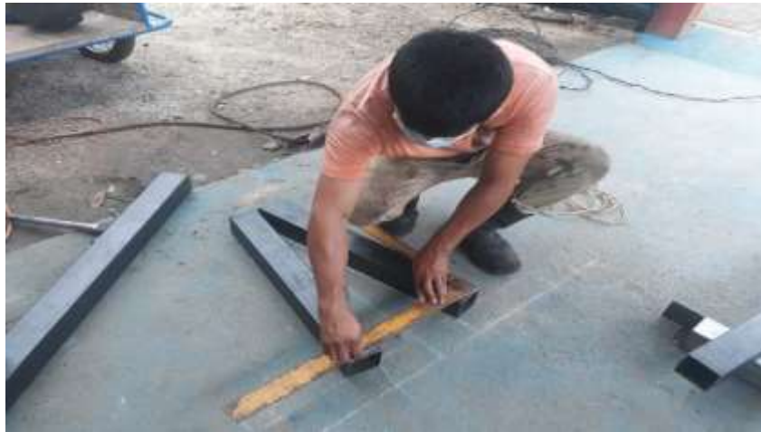
ANEXO D: ARMADA Y PUESTA A ESCUADRA TUBO CUADRADO DE LA PRIMERA SECCIÓN DE LA SURCADORA
