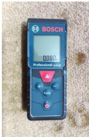
**Ilustración 3-1:** Medidor de distancia láser
