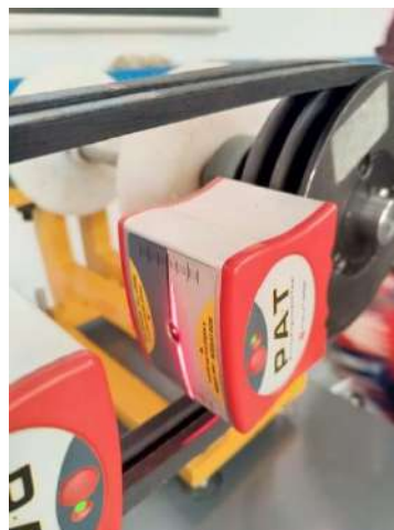
Ilustración 4-21: Desalineación en la patea conducida
