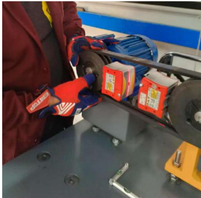
Ilustración 4-22: Proceso de alineación
