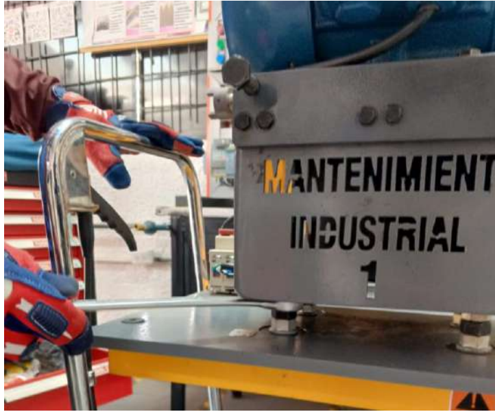
Ilustración 4-31: Ajuste de las contratuercas
