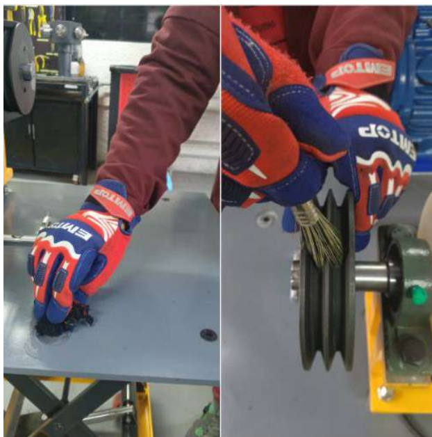
Ilustración 12-5. Limpieza del módulo móvil
