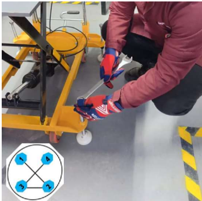
Ilustración 9-5. Nivelación de las patas de nylon
