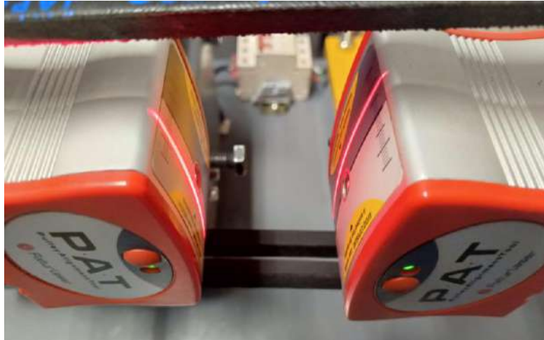
Ilustración 4-35: Corrección de la desalineación
