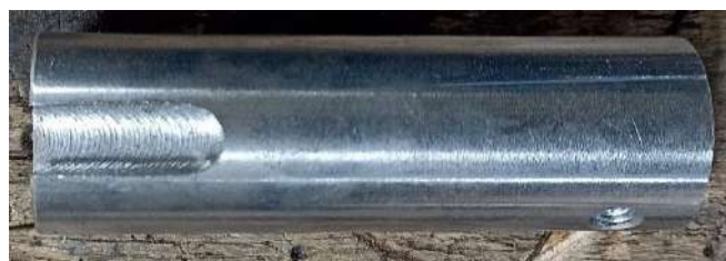
Ilustración 4-7: Manufactura del eje de acople
