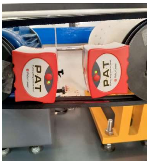
Ilustración 20-5. Montaje de unidades láser
