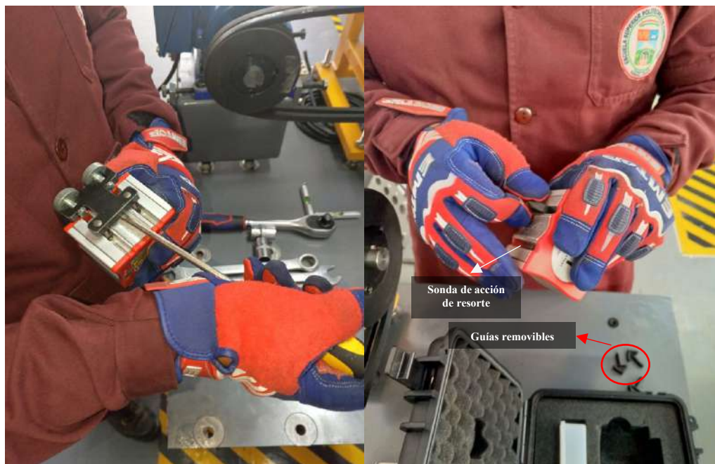
Ilustración 19-5. Preparación e instalación del alineador láser de poleas PAT II
