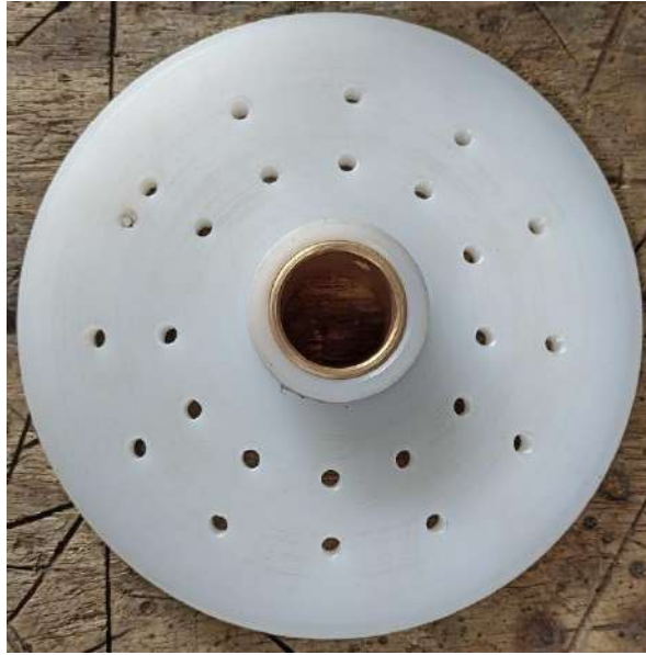
Ilustración 4-6: Manufactura del disco de desbalanceo
