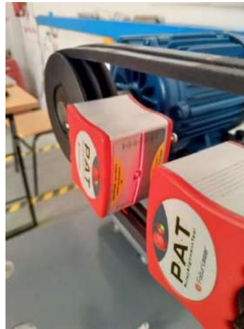
Ilustración 4-20: Desalineación en la patea motriz
