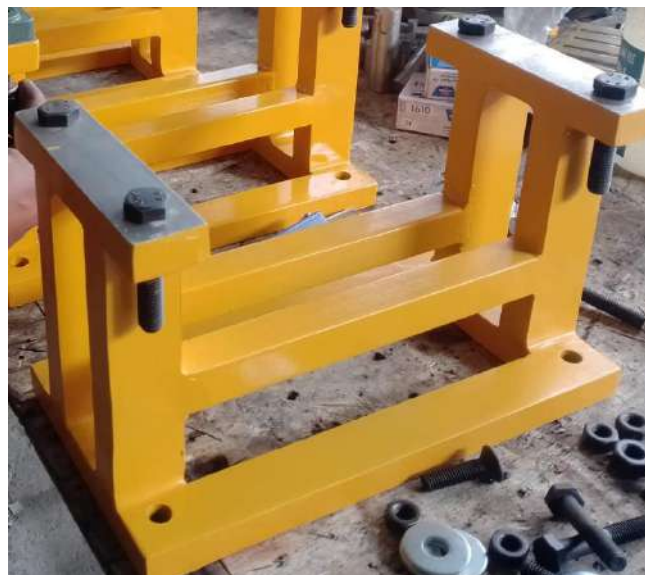
Ilustración 4-4: Manufactura de la estructura conducida
