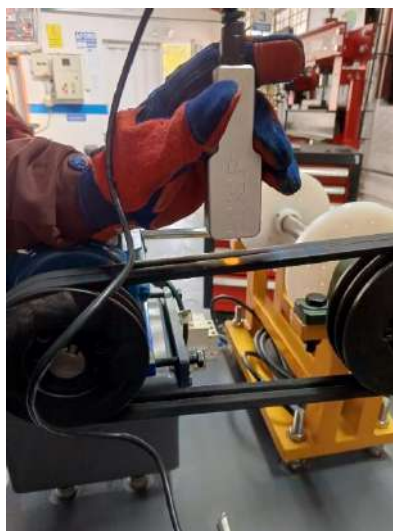
Ilustración 4-26: Verificación de tensión
