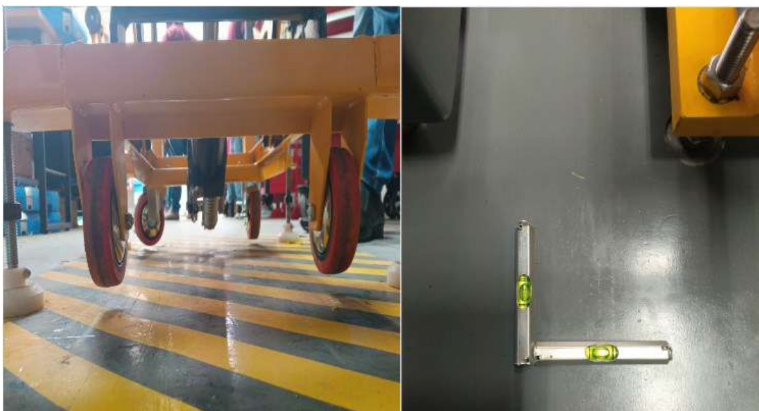
Ilustración 11-5. Correcta nivelación del módulo móvil
