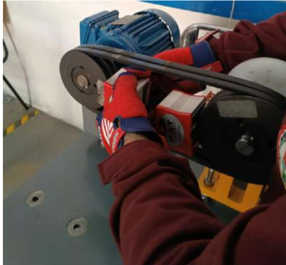
Ilustración 4-19: Montaje de los alineadores láser
