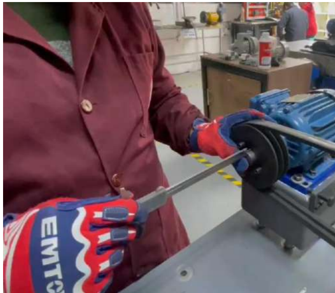
Ilustración 4-18: Simulación de la desalineación paralela
