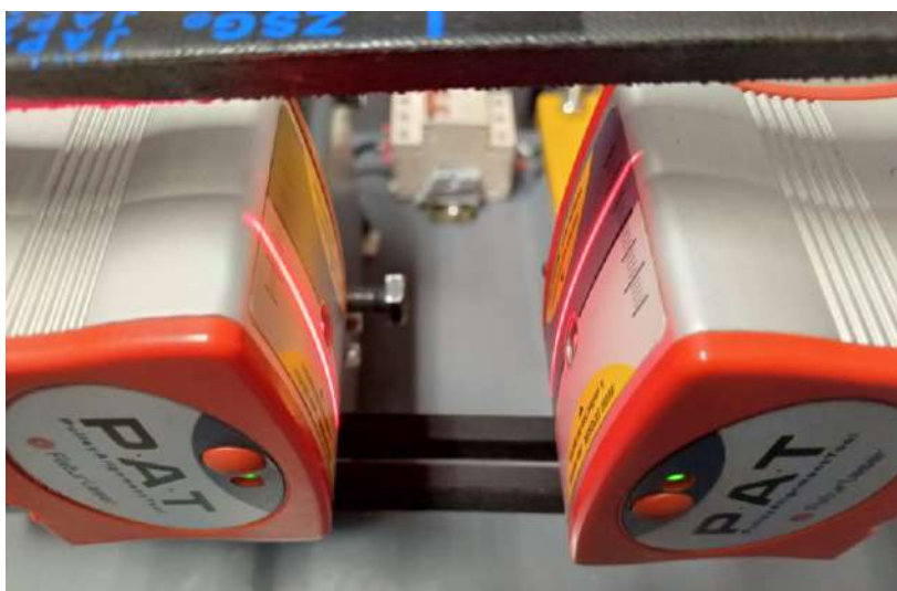
Ilustración 38-5. Referencia de la alineación corregida
