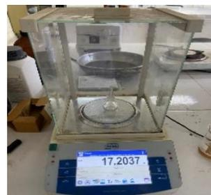
Gravedad específica con picnómetro
