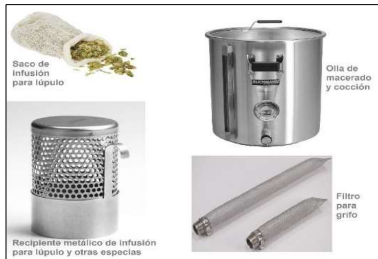
Ilustración 2-10: Elementos usados en la fase de cocción
