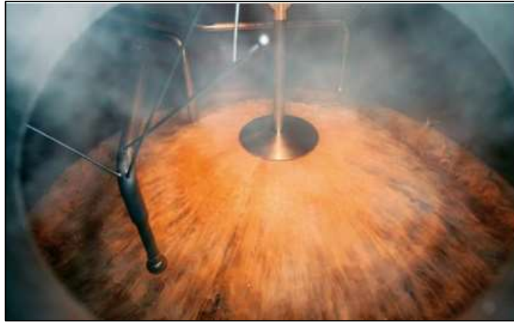
Ilustración 2-9: Recirculado del mosto
