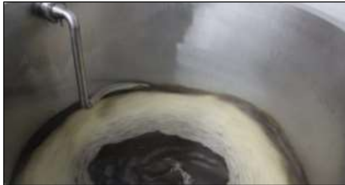
Ilustración 2-11: Remolino en el recipiente de cocción
