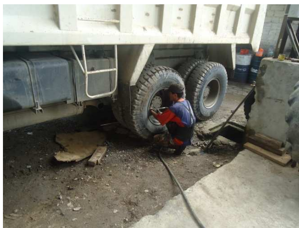
Figura 90. Trabajo de vulcanización sin implementos de seguridad
