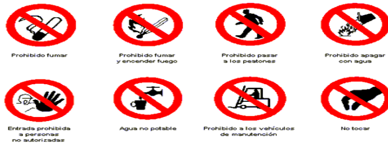
Figura 111. Señales de prohibición
