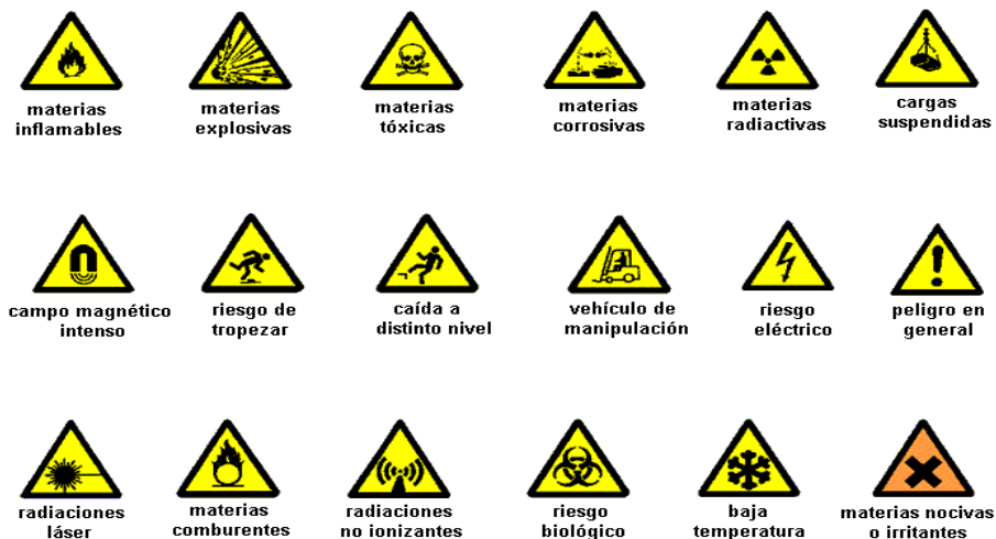
Figura 110. Señales de advertencia
