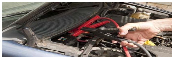
Figura 108. Carga de baterías
