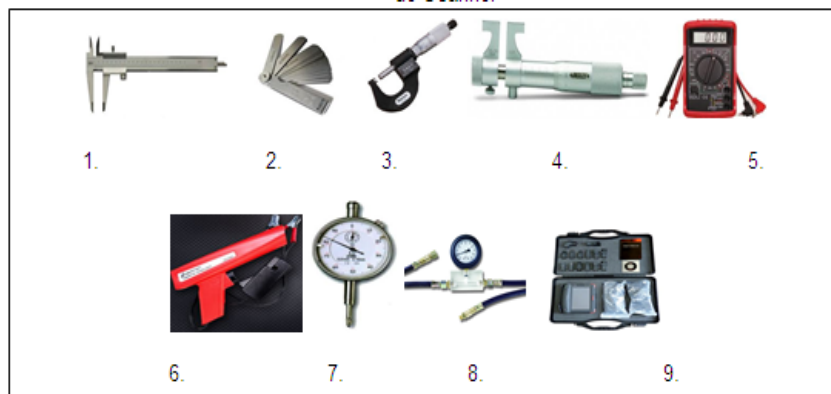
Figura 4. Herramientas de medición y comprobación; 1. Calibrador Vernier; 2. Calibrador de láminas; 3. Micrómetro de exteriores; 4. Micrómetro de interiores; 5. Multímetro; 6. Lámpara estroboscópica; 7. Reloj comparador; 8. Comprobador de la presión de combustible; 9. Equipo de Scanner
