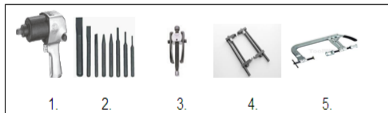
Figura 3. Herramientas de servicio especial (SST), 1.Pistola neumática; 2. Punzones; 3.Extractor; 4.Compresor de muelles de suspensión; 5.Prensa para muelles de válvulas
