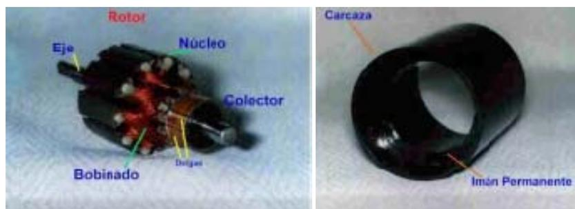
Fuente: Partes del motor del motor de corriente directa [5]
