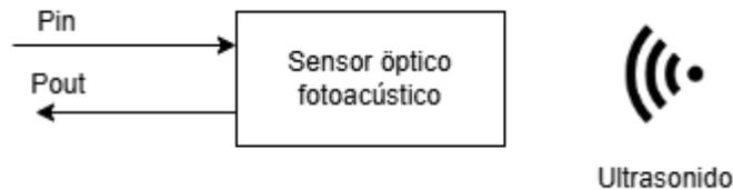
**Ilustración 3-10:** Sensor enfrentado a ultrasonido simulado
