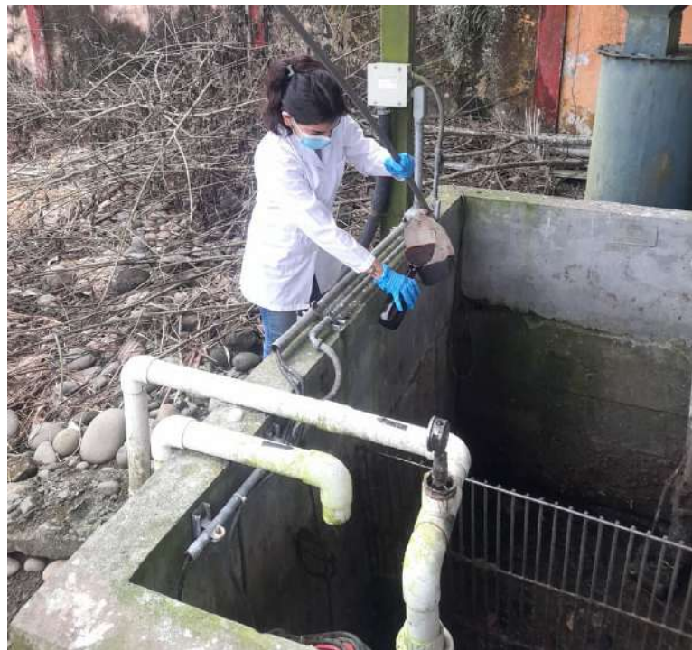
ANEXO C: TOMA DE MUESTRAS EN LA CAJA DE CAPTACIÓN DEL CAMAL MUNICIPAL LA JOYA DE LOS SACHAS.
