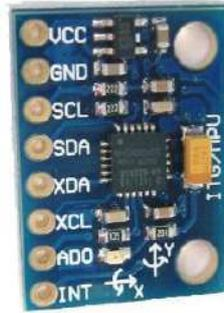
**Ilustración 9-2:** Sensor MPU6050 Acelerómetro y Giroscopio
