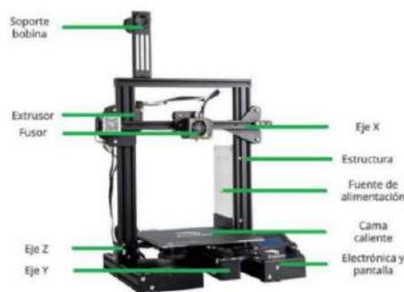
**Ilustración 5-2:** Impresora 3D FDM
