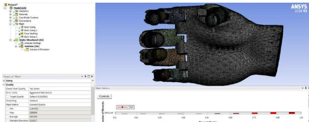
**Ilustración 39-3:** Mallado de agarre cilíndrico
