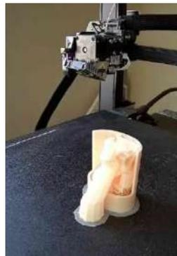
**Ilustración 43-3:** Impresión de la zona transradial (FDM)
