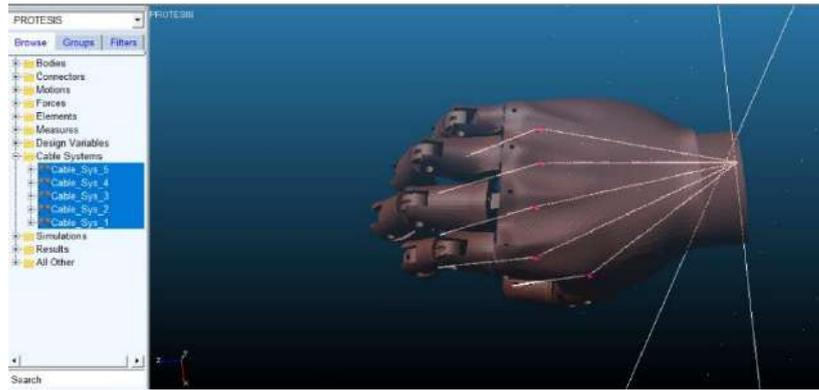
**Ilustración 29-3:** Sistemas de cables en cada dedo del modelo
