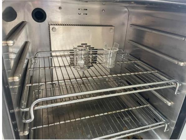
**Ilustración 3-15:** Cristalización de la membrana
