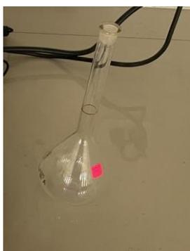
**Ilustración 3-2:** Matraz de aforo
