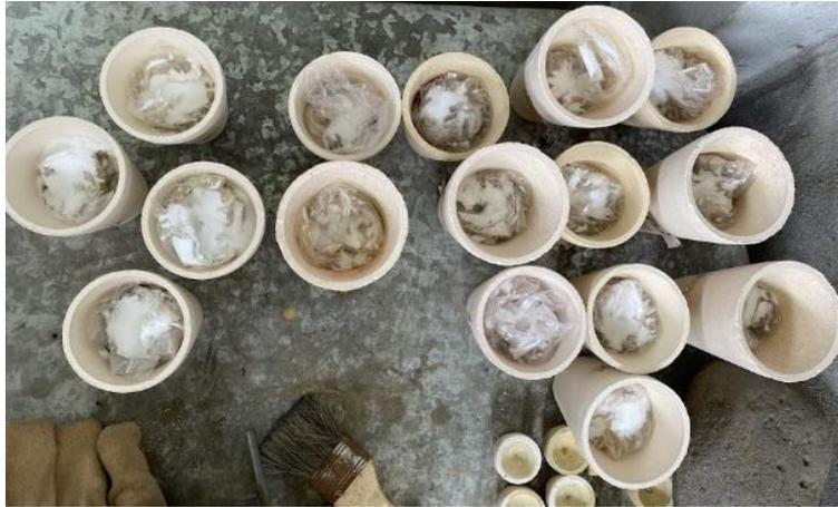
**Ilustración 3-10:** Crisoles de arcilla con las respectivas cargas para fundición en el ensayo a fuego.
