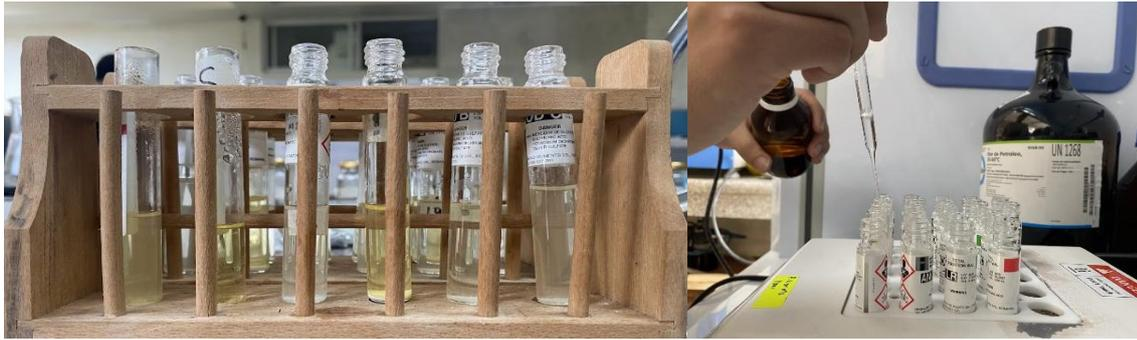
**Ilustración 3-14:** Digestión de botones de oro y plata con ácido nítrico y agua regia en un digestor electrónico.
