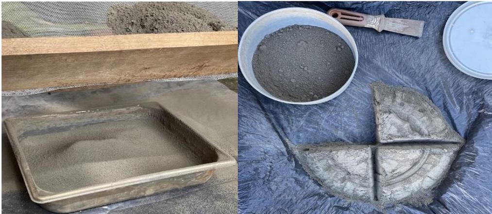
**Ilustración 3-2:** Homogenización, cuarteo y envasado de muestra de mineral de mena.
