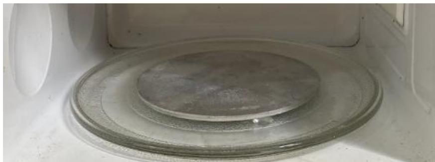
**Ilustración 3-5:** Colocación de placa de aluminio en la base del microondas.
