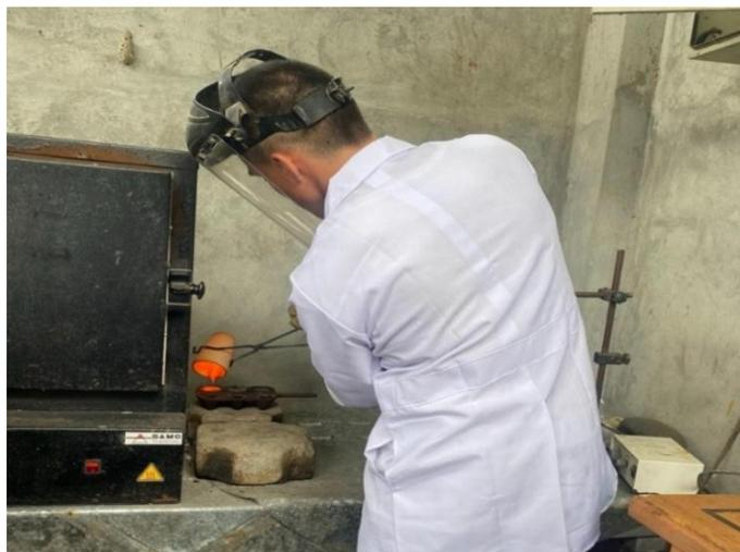
**Ilustración 3-11:** Vertido de fundido del ensayo a fuego sobre la lingotera.
