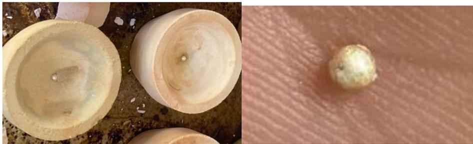
**Ilustración 3-13:** Copelas con plomo adherido y botones de oro y plata liberados.
