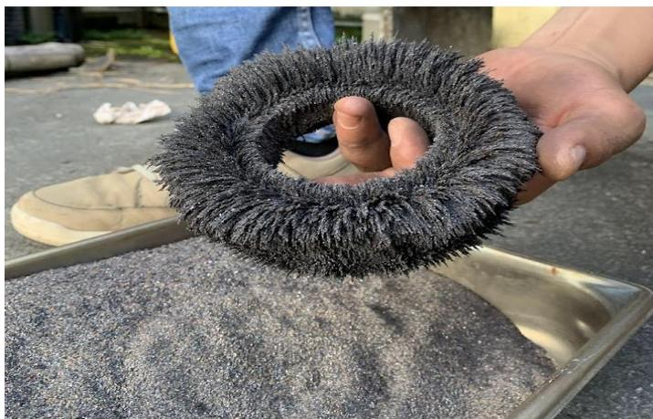
**Ilustración 3-3:** Separación de magnetita de otros minerales asociados paramagnéticos.
