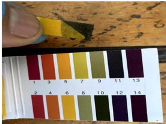
**Ilustración 3-7:** Verificación de pH de soluciones cianuradas con tiras de papel indicador.
