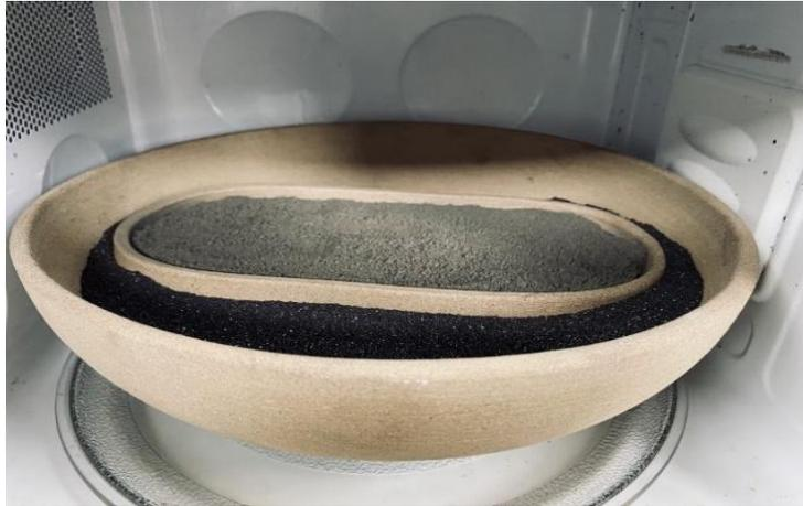
**Ilustración 3-6:** Proceso experimental del pretratamiento indirecto para mineral refractario mediante microondas y susceptor magnético.
