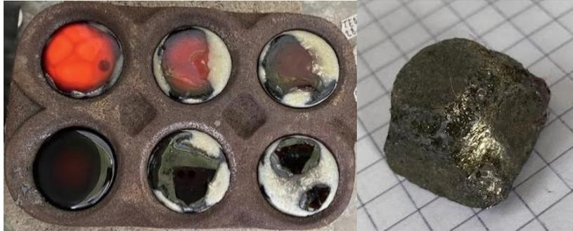
**Ilustración 3-12:** Cristalización y enfriamiento de líquido fundido sobre la lingotera (iz) y obtención de regulo de plomo (der).
