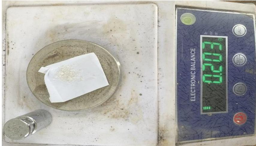
**Ilustración 3-8:** Colocación de cianuro de sodio sobre papel para pesaje y posterior adición al proceso de lixiviación.
