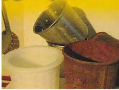
**Ilustración 2-1:** Moldes de acero inoxidable, latón y de plástico
