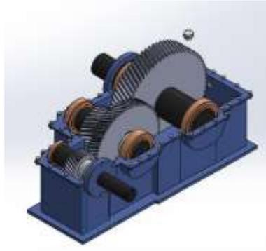
**Ilustración 2-10:** Reductor de velocidad de engranes
