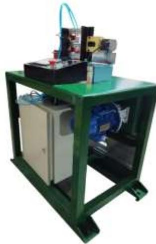
**Ilustración 3-41:** Ensamblaje final de la dobladora de platina
