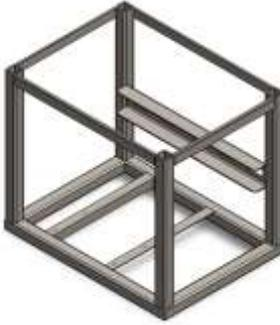
**Ilustración 3-35:** Estructura de la máquina dobladora
