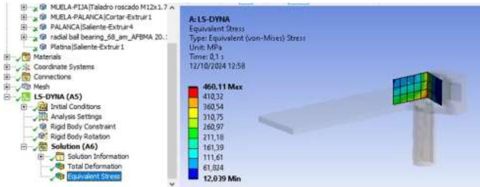
**Ilustración 4-13:** Movimiento del plegado de platina
