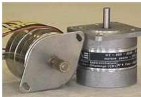
**Ilustración 2-11:** Motor paso a paso
