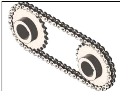
**Ilustración 2-6:**Sistema de transmisión de potencia por cadena
