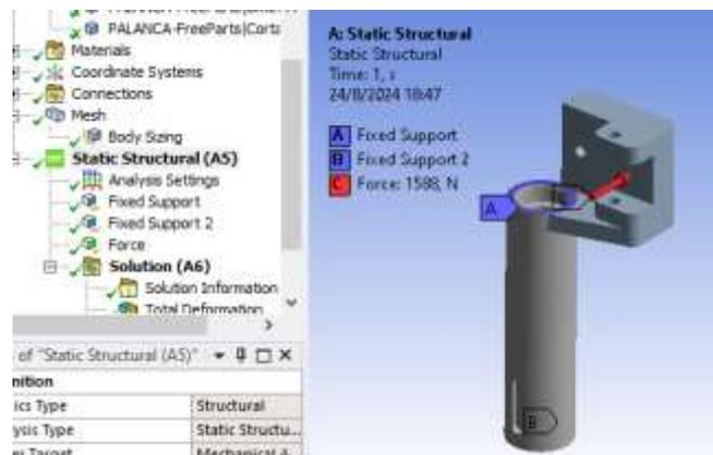
**Ilustración 3-53:** Condiciones de contorno y cargas aplicadas en la palanca de doblez
