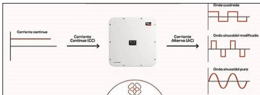
**Ilustración 2-27:** Tipos de ondas generadas por el inversor
