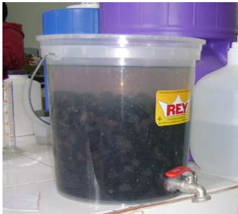
Foto 6. Determinación del caudal con una abertura de la llave
