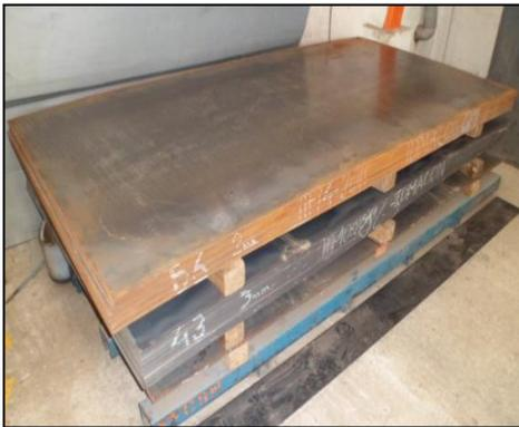
Altura de plancha de 3 mm = 0.30 m
