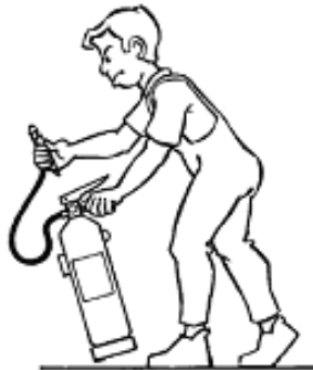
Figura 2. Manejo de extintores.
