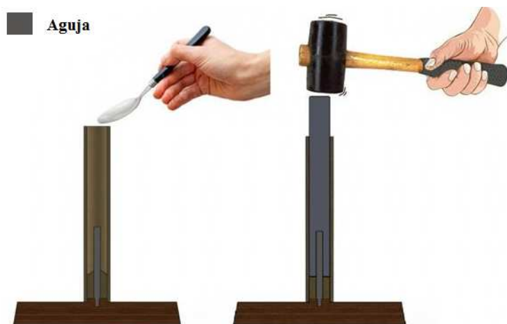
Figura 6. Dosificación y compactación de barro
