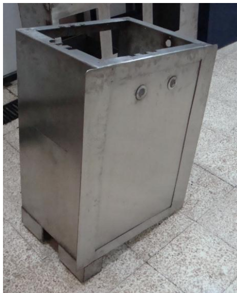
Figura 43. Construcción de la base del cilindro
