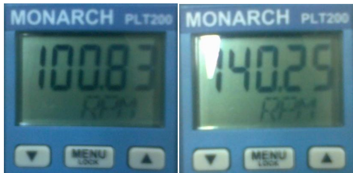
Figura 74. Velocidad V1 y V2 de la turbina obtenidas
