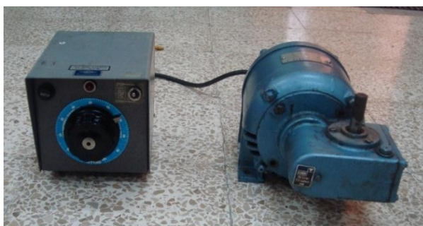
Figura 11. Motor eléctrico c.c y reóstato
