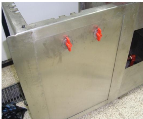
Figura 47. Montaje de las válvulas de carga y descarga
