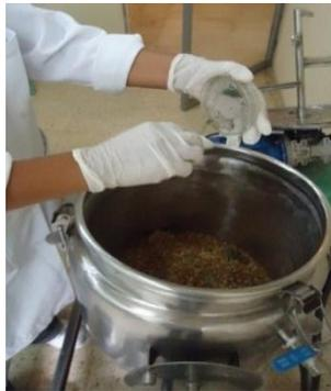
Colocar una caja de inculo solido por cada capa de sustrato que se coloque.
