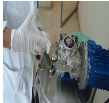
Una vez ya tapado el fermentador agregamos por clamp de 1 pulg 250 ml de inculo líquido.
