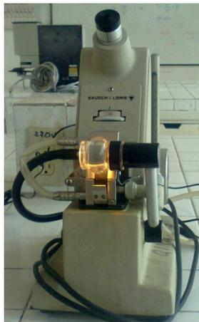
**FOTOGRAFÍA N° 9 Refractómetro**
