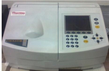
**FOTOGRAFÍA N° 11 Espectrofotómetro**
