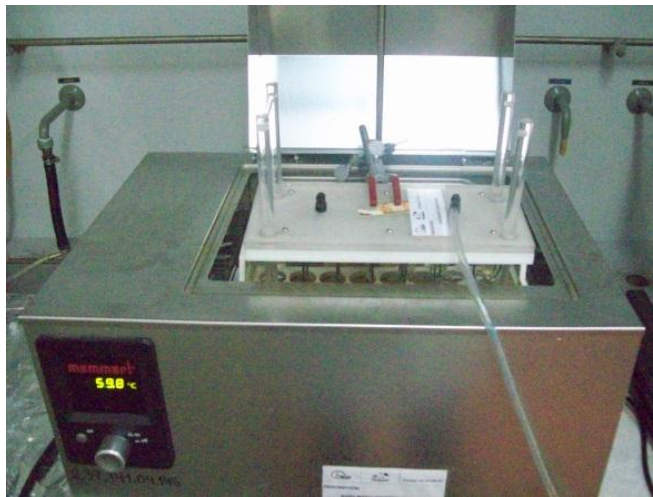
FOTOGRAFÍA No. 11 EVAPORACIÓN A SEQUEDAD DE LA MUESTRA RECUPERADA MEDIANTE GAS NITRÓGENO AL 99% DE PUREZA. LABORATORIO DE SERVICIOS DE ANÁLISIS E INVESTIGACIÓN EN ALIMENTOS (LSAIA). DEPARTAMENTO DE NUTRICIÓN Y CALIDAD. ESTACIÓN EXPERIMENTAL SANTA CATALINA. INIAP. CUTUGLAHUA. NOVIEMBRE DEL 2012.
