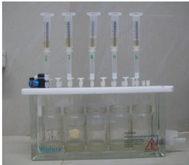
FOTOGRAFÍA No. 8 FILTRADO DEL EXTRACTO UTILIZANDO COLUMNAS DE INMUNOAFINIDAD. LABORATORIO DE SERVICIOS DE ANÁLISIS E INVESTIGACIÓN EN ALIMENTOS (LSAIA). DEPARTAMENTO DE NUTRICIÓN Y CALIDAD. ESTACIÓN EXPERIMENTAL SANTA CATALINA. INIAP. CUTUGLAHUA. NOVIEMBRE DEL 2012.
