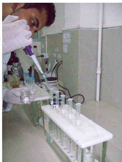
FOTOGRAFÍA No. 10 RECUPERACIÓN DEL DON CON 3 mL DE ACETONITRILLO GRADO HPLC. LABORATORIO DE SERVICIOS DE ANÁLISIS E INVESTIGACIÓN EN ALIMENTOS (LSAIA). DEPARTAMENTO DE NUTRICIÓN Y CALIDAD. ESTACIÓN EXPERIMENTAL SANTA CATALINA. INIAP. CUTUGLAHUA. NOVIEMBRE DEL 2012.
