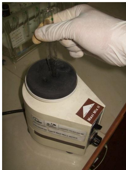
FOTOGRAFÍA No. 12 RECONSTITUCIÓN DE LA MUESTRA CON 300 \mu L DE FASE MÓVIL Y AGITACIÓN POR 3 MINUTOS. LABORATORIO DE SERVICIOS DE ANÁLISIS E INVESTIGACIÓN EN ALIMENTOS (LSAIA). DEPARTAMENTO DE NUTRICIÓN Y CALIDAD. ESTACIÓN EXPERIMENTAL SANTA CATALINA. INIAP. CUTUGLAHUA. NOVIEMBRE DEL 2012.
