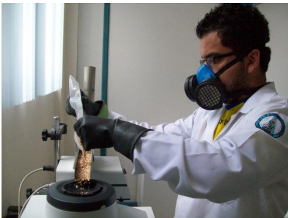
FOTOGRAFÍA No. 3 PROCESO DE MOLIENDA DEL TRIGO. LABORATORIO DE SERVICIOS DE ANÁLISIS E INVESTIGACIÓN EN ALIMENTOS (LSAIA). DEPARTAMENTO DE NUTRICIÓN Y CALIDAD. ESTACIÓN EXPERIMENTAL SANTA CATALINA. INIAP. CUTUGLAHUA. AGOSTO DEL 2012.
