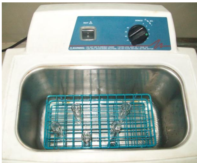
FOTOGRAFÍA No. 13 HOMOGENIZACIÓN DE LA MUESTRA EN BAÑO ULTRASONIDO POR 5 MINUTOS. LABORATORIO DE SERVICIOS DE ANÁLISIS E INVESTIGACIÓN EN ALIMENTOS (LSAIA). DEPARTAMENTO DE NUTRICIÓN Y CALIDAD. ESTACIÓN EXPERIMENTAL SANTA CATALINA. INIAP. CUTUGLAHUA. NOVIEMBRE DEL 2012.
