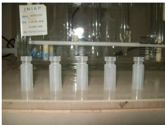
FOTOGRAFÍA No. 14 COLOCACIÓN DE LAS MUESTRAS EN LOS VIALES DE 200 µL CON INSERTO FIJO Y UBICACIÓN DE LOS MISMOS EN EL AUTOSAMPLER DEL EQUIPO HPLC AGILENT 1200. LABORATORIO DE SERVICIOS DE ANÁLISIS E INVESTIGACIÓN EN ALIMENTOS (LSAIA). DEPARTAMENTO DE NUTRICIÓN Y CALIDAD. ESTACIÓN EXPERIMENTAL SANTA CATALINA. INIAP. CUTUGLAHUA. NOVIEMBRE DEL 2012.
