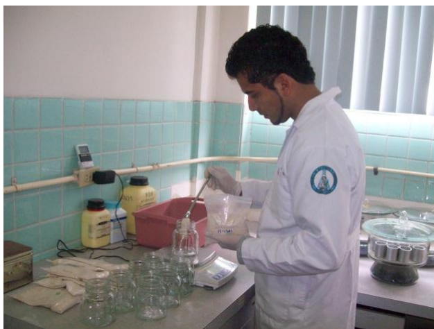
FOTOGRAFÍA No. 4 PESAJE DE 25 g DE MUESTRA. LABORATORIO DE SERVICIOS DE ANÁLISIS E INVESTIGACIÓN EN ALIMENTOS (LSAIA). DEPARTAMENTO DE NUTRICIÓN Y CALIDAD. ESTACIÓN EXPERIMENTAL SANTA CATALINA. INIAP. CUTUGLAHUA. NOVIEMBRE DEL 2012.
