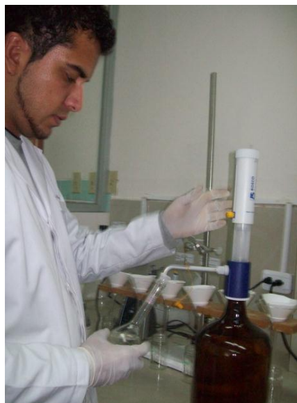
FOTOGRAFÍA No. 5 AFORACIÓN DE 200 mL DE AGUA BIDEDESTILADA. LABORATORIO DE SERVICIOS DE ANÁLISIS E INVESTIGACIÓN EN ALIMENTOS (LSAIA). DEPARTAMENTO DE NUTRICIÓN Y CALIDAD. ESTACIÓN EXPERIMENTAL SANTA CATALINA. INIAP. CUTUGLAHUA. NOVIEMBRE DEL 2012.
