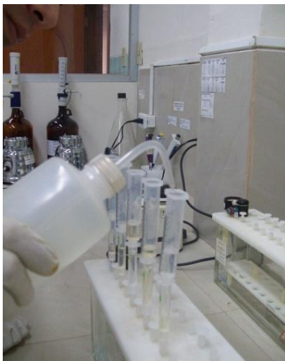
FOTOGRAFÍA No. 9 LAVADO DE LA COLUMNA DE INMUNOAFINIDAD CON 10 mL DE AGUA BIDESTILADA. LABORATORIO DE SERVICIOS DE ANÁLISIS E INVESTIGACIÓN EN ALIMENTOS (LSAIA). DEPARTAMENTO DE NUTRICIÓN Y CALIDAD. ESTACIÓN EXPERIMENTAL SANTA CATALINA. INIAP. CUTUGLAHUA. NOVIEMBRE DEL 2012.
