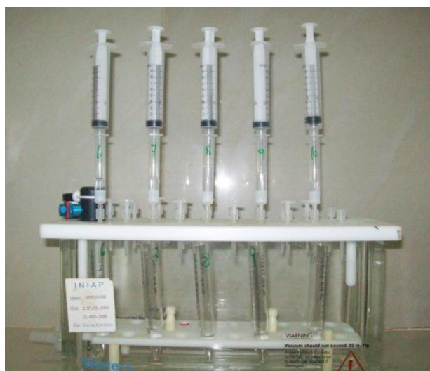
FOTOGRAFÍA No. 10 RECUPERACIÓN DEL DON CON 3 mL DE ACETONITRILLO GRADO HPLC. LABORATORIO DE SERVICIOS DE ANÁLISIS E INVESTIGACIÓN EN ALIMENTOS (LSAIA). DEPARTAMENTO DE NUTRICIÓN Y CALIDAD. ESTACIÓN EXPERIMENTAL SANTA CATALINA. INIAP. CUTUGLAHUA. NOVIEMBRE DEL 2012.
