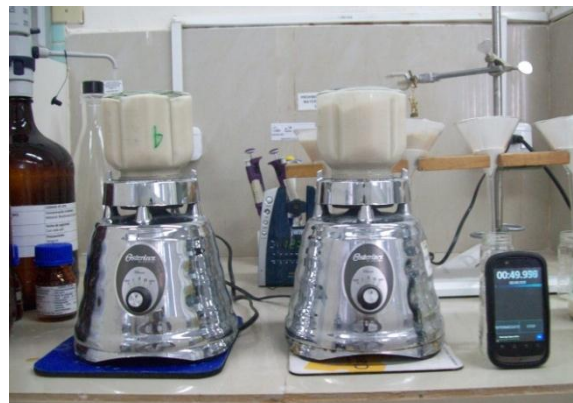
FOTOGRAFÍA No. 6 EXTRACCIÓN DE LA MUESTRA MEDIANTE 200 mL DE AGUA ULTRAPURA Y LICUADO POR 3 MINUTOS. LABORATORIO DE SERVICIOS DE ANÁLISIS E INVESTIGACIÓN EN ALIMENTOS (LSAIA). DEPARTAMENTO DE NUTRICIÓN Y CALIDAD. ESTACIÓN EXPERIMENTAL SANTA CATALINA. INIAP. CUTUGLAHUA. NOVIEMBRE DEL 2012.
