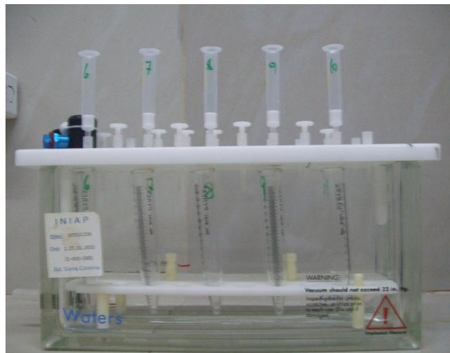
FOTOGRAFÍA No. 9 LAVADO DE LA COLUMNA DE INMUNOAFINIDAD CON 10 mL DE AGUA BIDESTILADA. LABORATORIO DE SERVICIOS DE ANÁLISIS E INVESTIGACIÓN EN ALIMENTOS (LSAIA). DEPARTAMENTO DE NUTRICIÓN Y CALIDAD. ESTACIÓN EXPERIMENTAL SANTA CATALINA. INIAP. CUTUGLAHUA. NOVIEMBRE DEL 2012.
