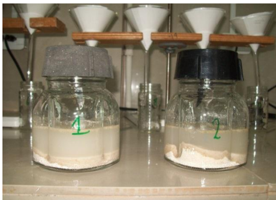
FOTOGRAFÍA No. 6 EXTRACCIÓN DE LA MUESTRA MEDIANTE 200 mL DE AGUA ULTRAPURA Y LICUADO POR 3 MINUTOS. LABORATORIO DE SERVICIOS DE ANÁLISIS E INVESTIGACIÓN EN ALIMENTOS (LSAIA). DEPARTAMENTO DE NUTRICIÓN Y CALIDAD. ESTACIÓN EXPERIMENTAL SANTA CATALINA. INIAP. CUTUGLAHUA. NOVIEMBRE DEL 2012.
