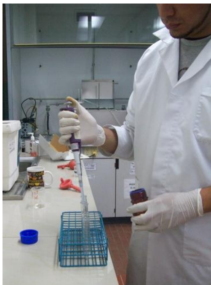
FOTOGRAFÍA No. 12 RECONSTITUCIÓN DE LA MUESTRA CON 300 \mu L DE FASE MÓVIL Y AGITACIÓN POR 3 MINUTOS. LABORATORIO DE SERVICIOS DE ANÁLISIS E INVESTIGACIÓN EN ALIMENTOS (LSAIA). DEPARTAMENTO DE NUTRICIÓN Y CALIDAD. ESTACIÓN EXPERIMENTAL SANTA CATALINA. INIAP. CUTUGLAHUA. NOVIEMBRE DEL 2012.
