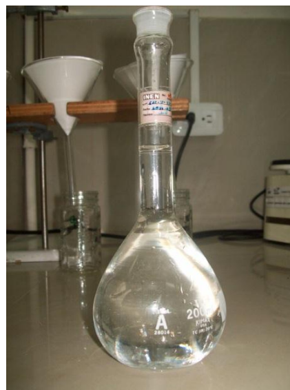
FOTOGRAFÍA No. 5 AFORACIÓN DE 200 mL DE AGUA BIDEDESTILADA. LABORATORIO DE SERVICIOS DE ANÁLISIS E INVESTIGACIÓN EN ALIMENTOS (LSAIA). DEPARTAMENTO DE NUTRICIÓN Y CALIDAD. ESTACIÓN EXPERIMENTAL SANTA CATALINA. INIAP. CUTUGLAHUA. NOVIEMBRE DEL 2012.
