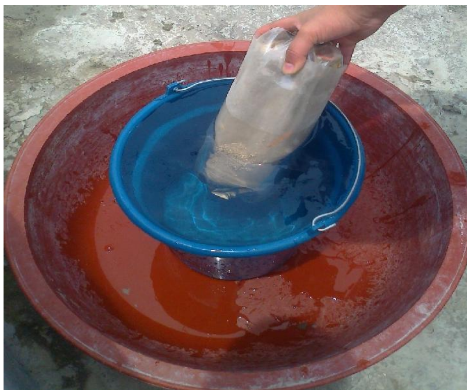
FOTO No 7 y 8. Sumergido de las unidades estructurales para la medición de las pruebas físicas
