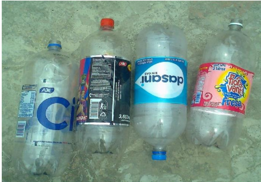
FOTO No 1. Botellas utilizadas en la elaboración de las unidades estructurales
