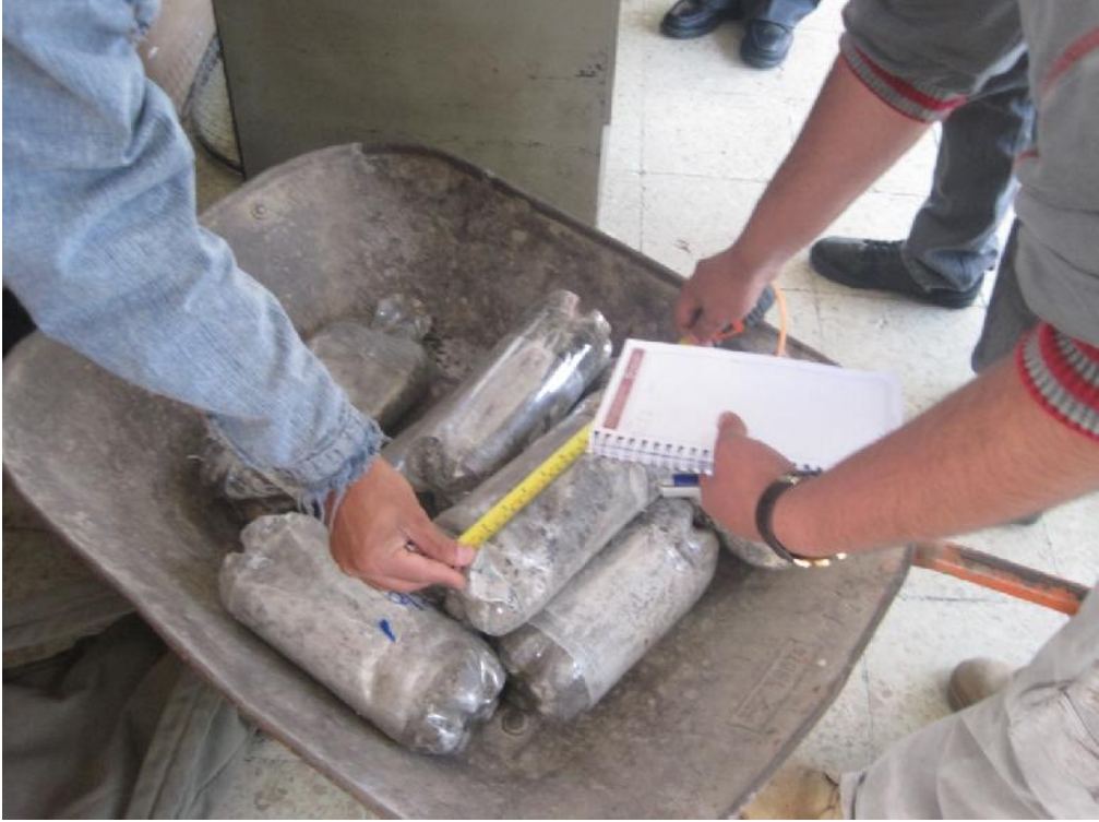
FOTO No 9 y 10. Medición de las unidades estructurales para el ensayo de compresión
