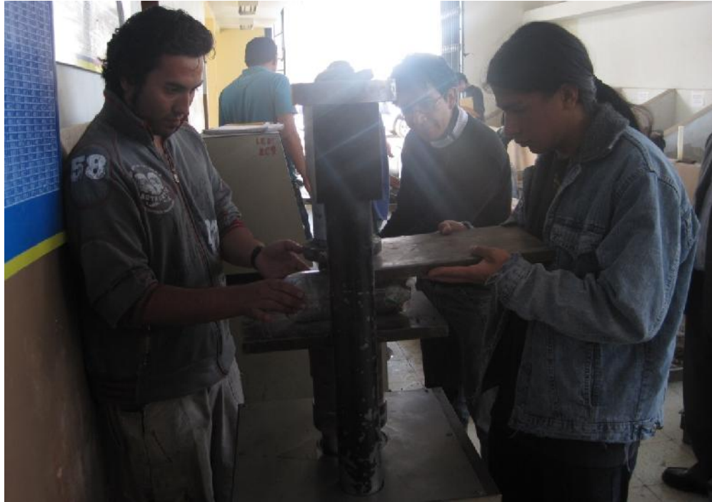
FOTO No 11. Preparación de las unidades estructurales para el ensayo
