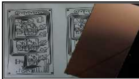
Figura 40. Placa del mando de control NI myDAQ diseñada
