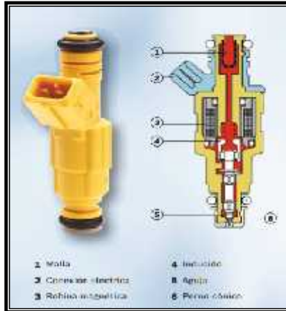
Figura 9. Componentes de un inyector
