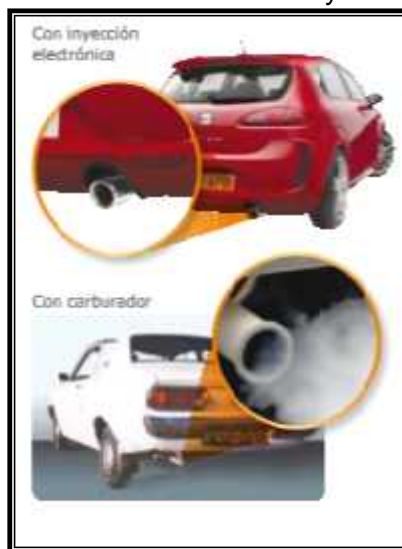
Figura1. Diferencias carburador vs inyección electrónica
