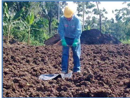
Fig. 2.2.2-1 Toma de muestras de suelo contaminado con hidrocarburo para la elaboración de un consorcio bacteriano
