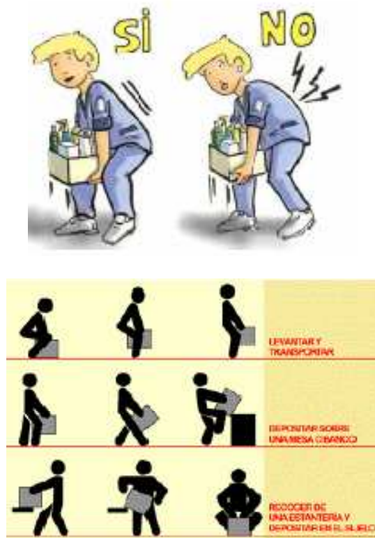
Figura 37: Levantamiento de correcto de cargas.
