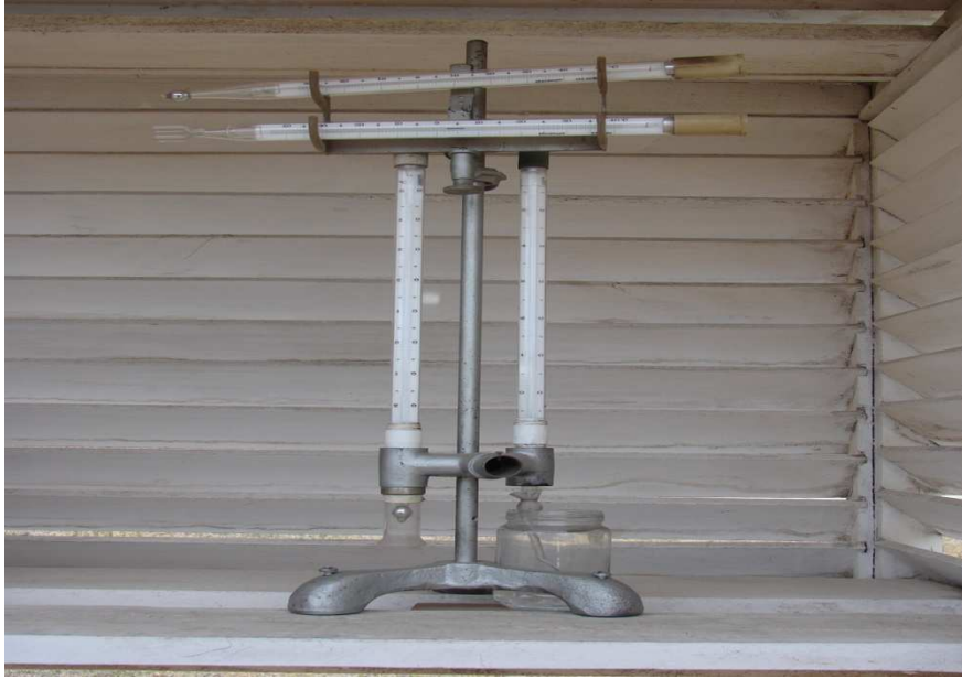
Fig. 3.2. Termómetro ambiental y termo higrómetro
